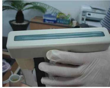
(b) Probe에 couplant holder 장착
