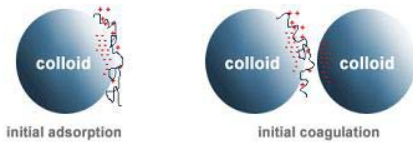
[그림 3.3.13] 고분자 응집제에 의한 흡착 가교 작용
