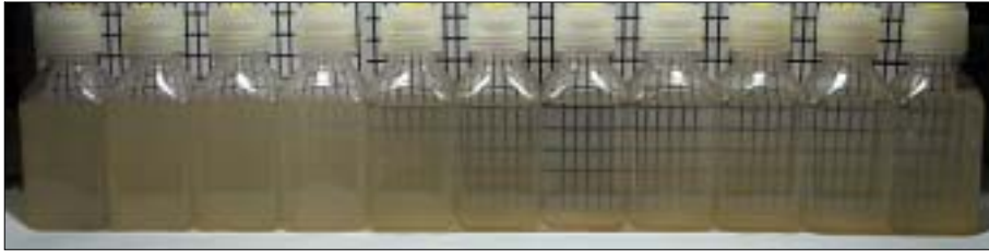
[그림 3.3.17] 실험에서 사용한 jar test(대조구는 11개의 병 중 제일 좌측의 병을 말한다. 대조구 오른쪽 10개의 병들은 첨가량을 조금씩 증가시켜 달리 넣어준 실험구이다)
