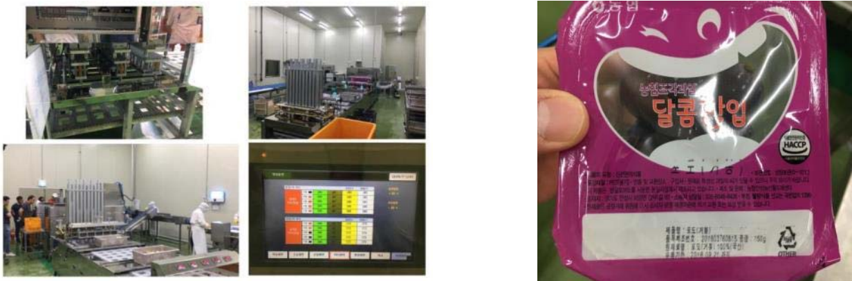
그림. 51. 커팅과일 용기 5열 자동실링작업 및 최종제품
