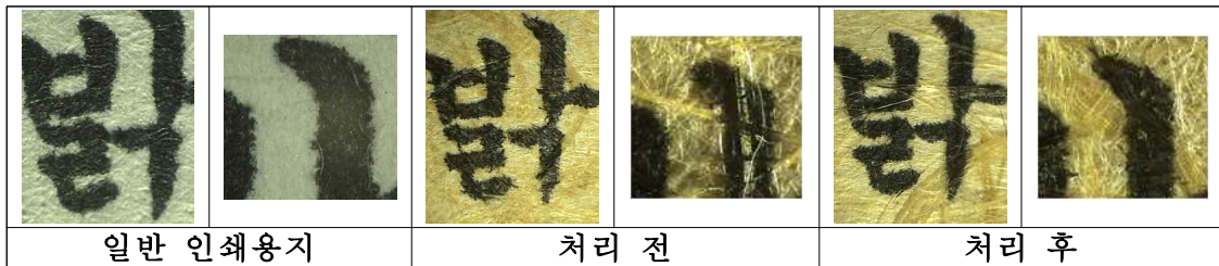
Figure 116B. Hemp 라벨지의 사이징과 캘린더링 처리 유무에 따른 인쇄물의 번짐 정도 차이
