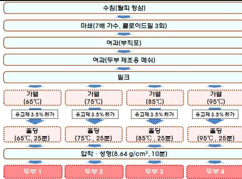
Figure 62. 가열온도를 달리한 청삼종실 압착식 제조 공정도
