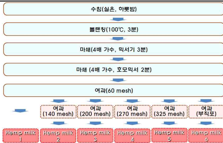
Figure 14. 여과메쉬별 종실 밀크의 제조 공정도
