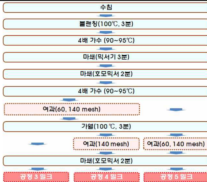
Figure 19. 종실 마쇄물의 여과공정 적용 시기를 달리한 밀크 제조 공정도
