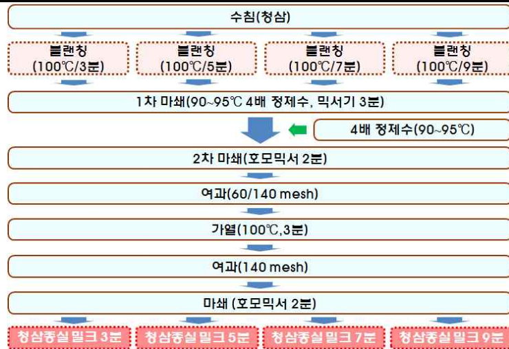
Figure 17. 청삼중실의 블랜칭 시간을 달리한 밀크의 제조 공정도
