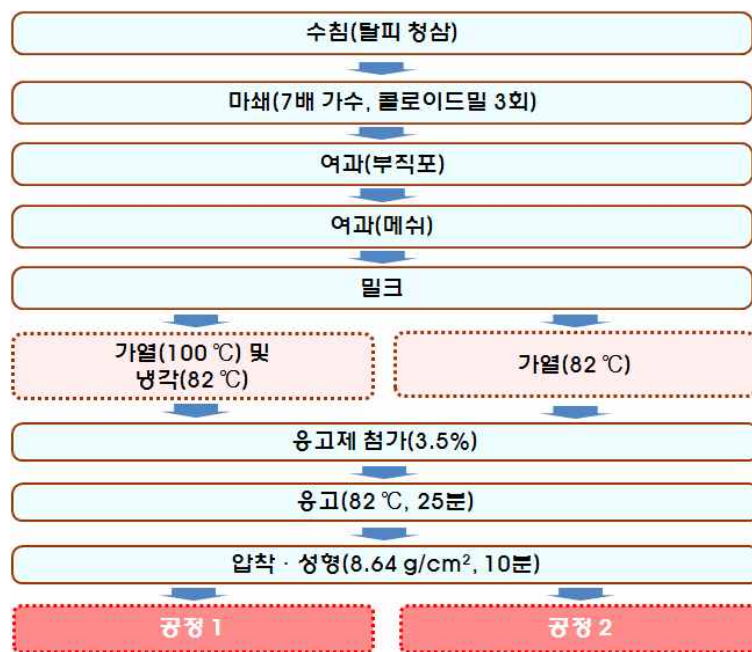
Figure 61. 제조공정에 따른 청삼종실 두부 제조 공정도
