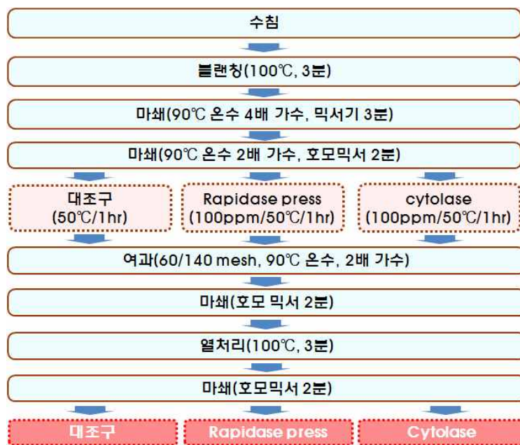
Figure 16. 효소처리에 의한 종실 밀크의 제조 공정도
