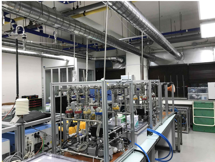
그림 10. PM 중량 측정 및 PAHs 분석을 위한 필터 포집 장치
