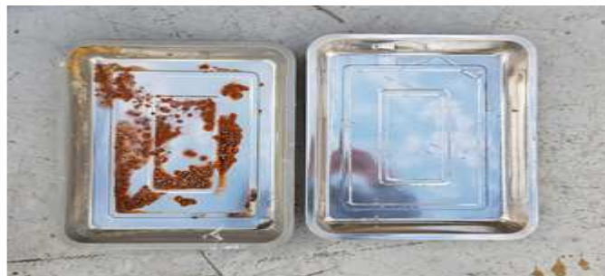
<그림54> 황 훈증 내부 금속 산화 사진
