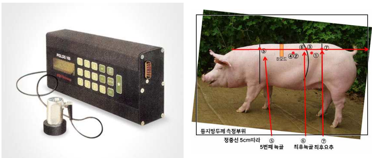
[그림 2-1] A-모드(PIGLOG105) 초음파기계를 활용한 등지방두께 측정부위
