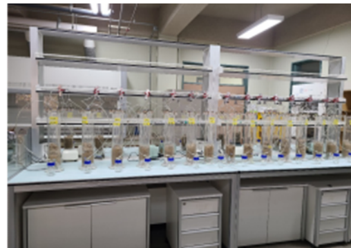
그림. 10 Ammonia acid trapping method 모식도 및 컬럼 사진
