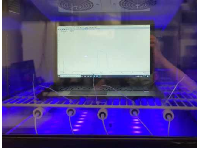
그림 9. 스펙트로미터를 활용한 UV LED 방출도 측정.
