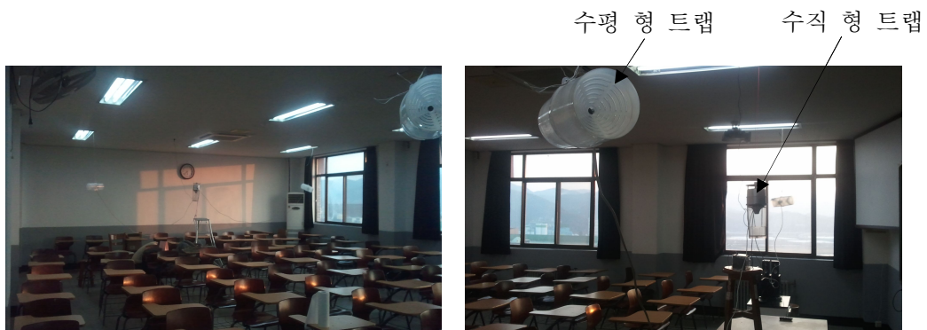
그림 5. 아날로그 해충 감지센서가 장착된 수직 형 트랩과 디지털 형 해충 감지센서가 장착된 수평 트랩의 실내 실험 광경
