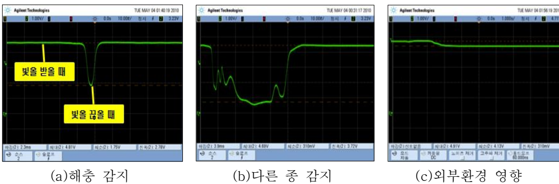
그림 2. 아날로그 형 해충 감지센서의 신호 파형
