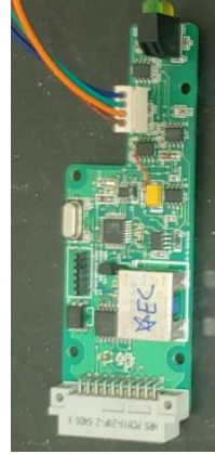
그림 9. 2차 Sallen-key filter topology (좌) 및 실제 제작 구성된 PCB 회로 필터 (우)
