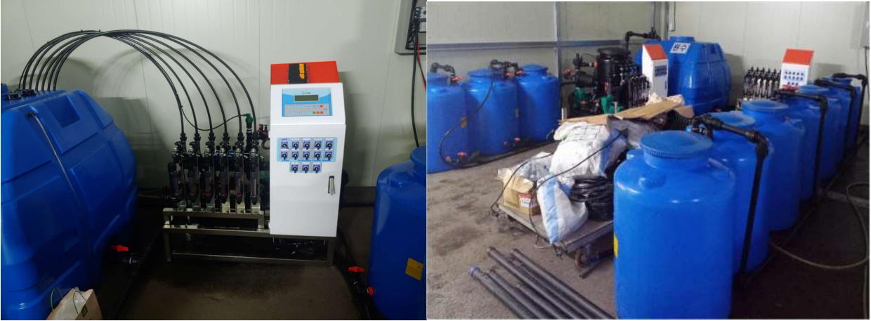
그림 23. 2차 정밀 양액 제어기 설치 사진: 이온 센싱 챔버 및 단비 주입부 (좌), 제어기 전체 설치도 (우)
