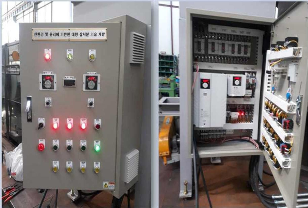
✓ 운전 제어시스템: main 전원, 송풍기, 스크류, 약품탱크, LD FAN on/off 제어시스템 및 상용화 실증
