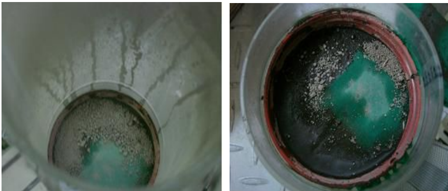
그림 3-2-25. 유동상태에서 가수에 의한 분진의 수분흡수 및 오염상태
