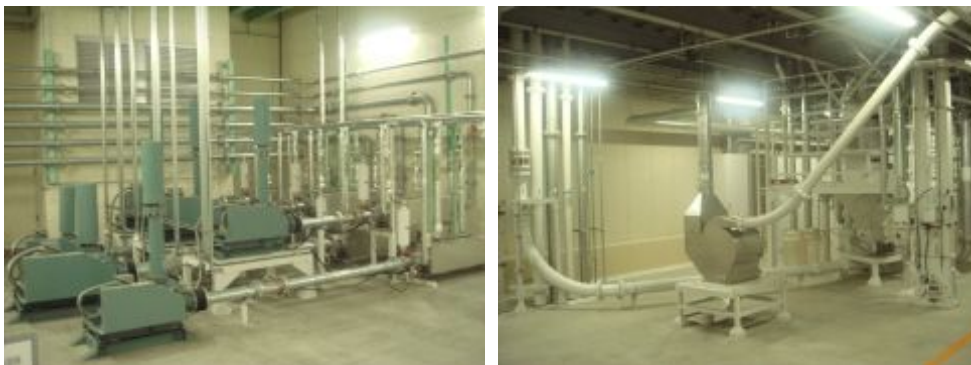
그림 3-1-17. 일본 정미공장에서 Pneumatic conveying을 위해 설치하고 있는 고압 blower, 가습, 냉각장치 및 receiver
