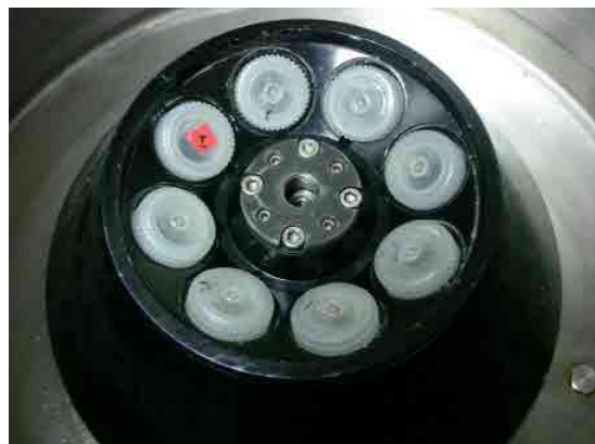
그림 3-2-21. 수분흡습지수 측정에 사용한 실험장치(고속 원심분리기)
