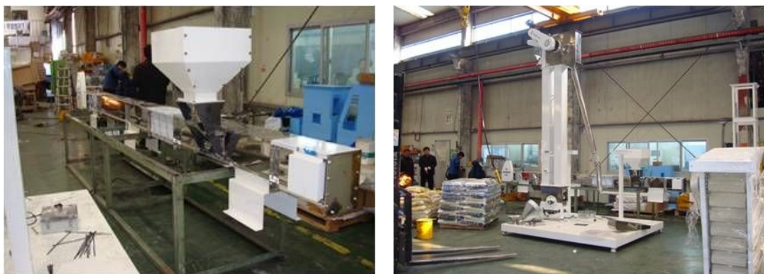
그림 3-1-16. 대원GSI에서 실시한 버킷엘리베이터와 체인컨베이어의 소요동력 실험장면
