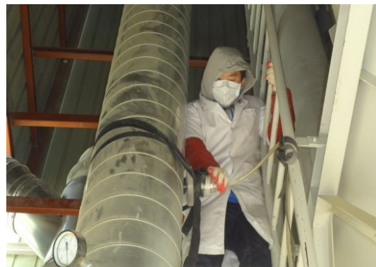
분진 농도 측정
