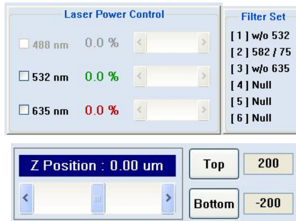
그림 75. Serial 통신을 이용한 motorized filter wheel의 구동 test
