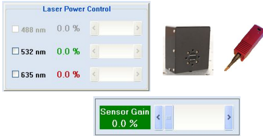
그림 73. 형광 검출시스템 구동 제어 S/W 및 outpower 조절 모듈
