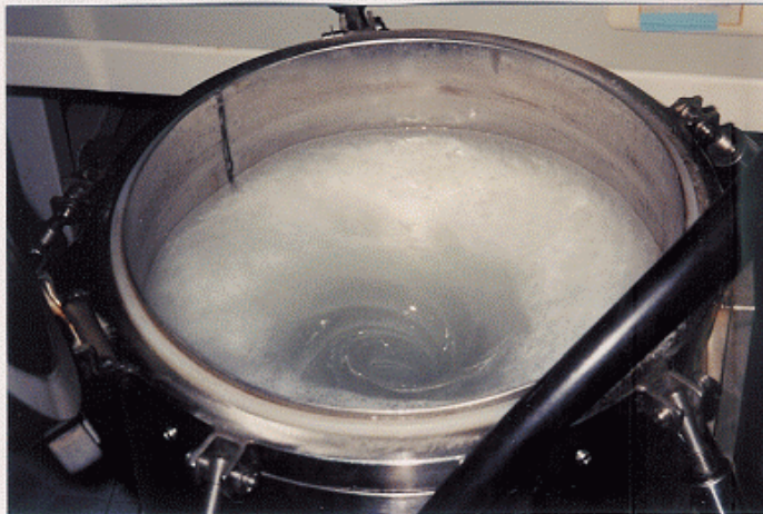
酸 가스는 알칼리液과 turbulence로 작은 방울 分散, 回轉→中和處理.
