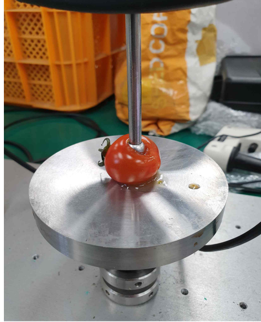
그림 11. 압축에 의한 항복점 측정
