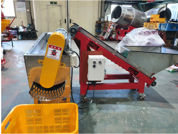
그림 51. 자동 꼭지제거기 최종 시제품
