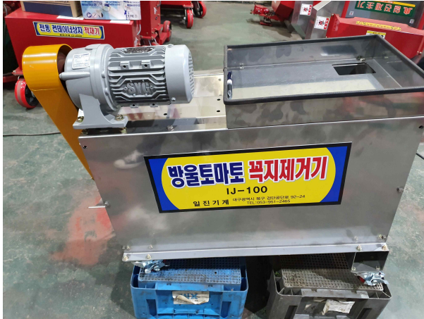
그림 47. 반자동 꼭지제거기 최종 시제품
