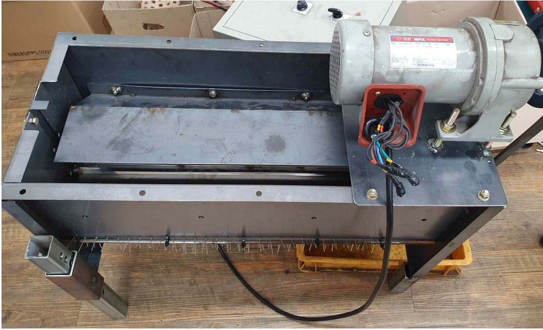
그림 43. 회전형으로 제작된 방울토마토 꼭지제거장치 시작기
