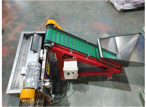
그림 52. 자동 꼭지제거기 방울토마토 투입부
