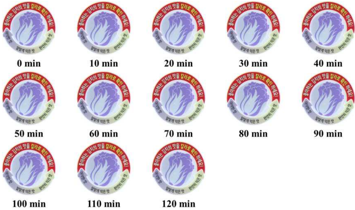
그림 114. pH 3 버퍼용액 노출 시, 시간에 따른 이산화탄소 감지 변색 결과: 좌측 상단 (최초) 에서부터 우측으로 10분 간격으로 최대 120분간 측정
