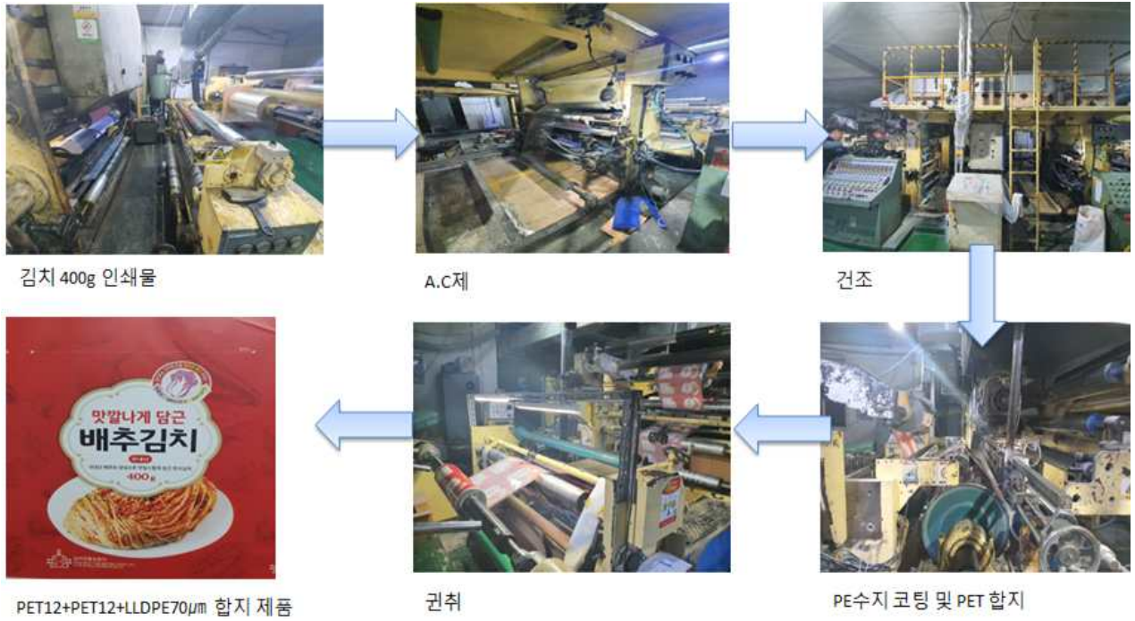
그림 25. 김치 파우치 400g T-die수지코팅 공정 사진
