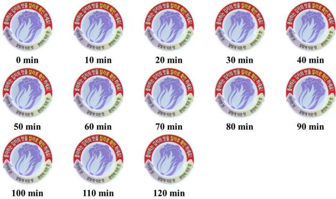
그림 124. pH 8 버퍼용액 노출 시, 시간에 따른 이산화탄소 감지 변색 결과: 좌측 상단 (최초)에서부터 우측으로 10분 간격으로 최대 120분간 측정
