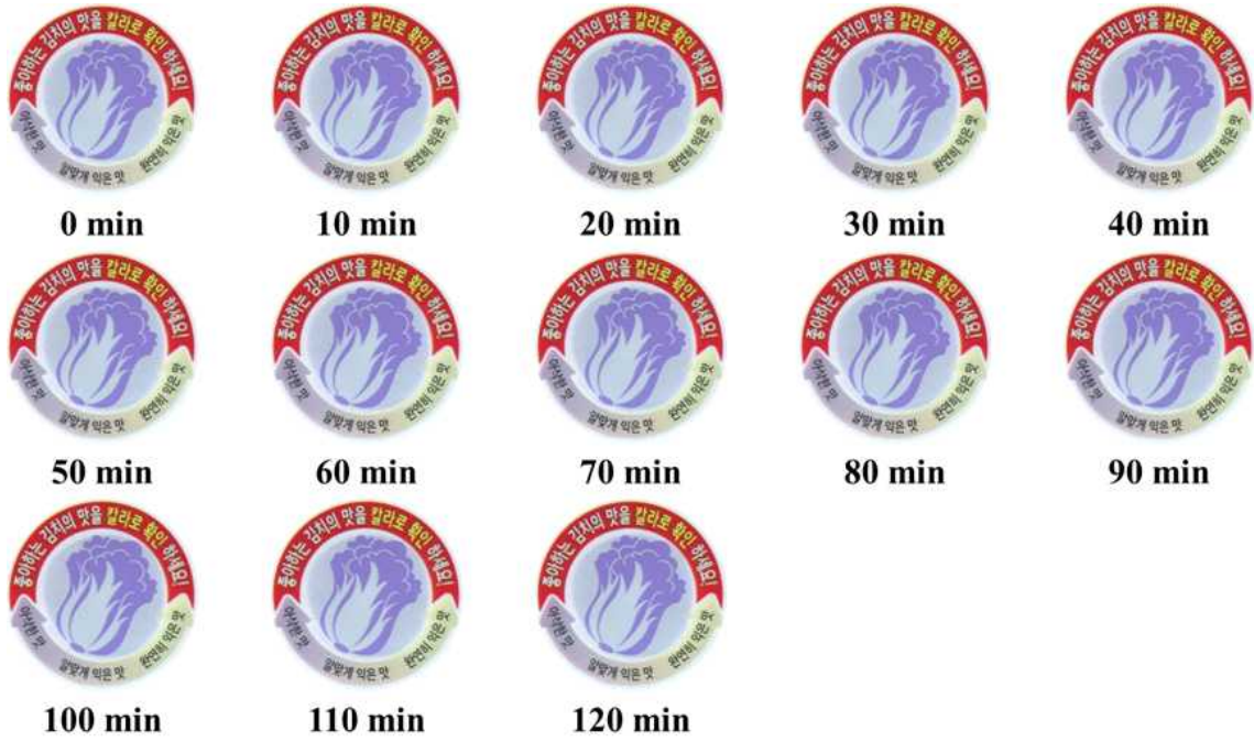
그림 122. pH 7 버퍼용액 노출 시, 시간에 따른 이산화탄소 감지 변색 결과: 좌측 상단 (최초) 에서부터 우측으로 10분 간격으로 최대 120분간 측정
