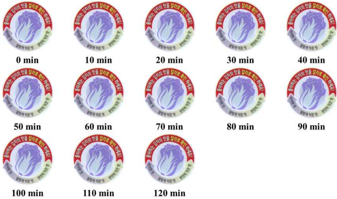
그림 132. pH 12 버퍼용액 노출 시, 시간에 따른 이산화탄소 감지 변색 결과: 좌측 상단 (최초) 에서부터 우측으로 10분 간격으로 최대 120분간 측정
