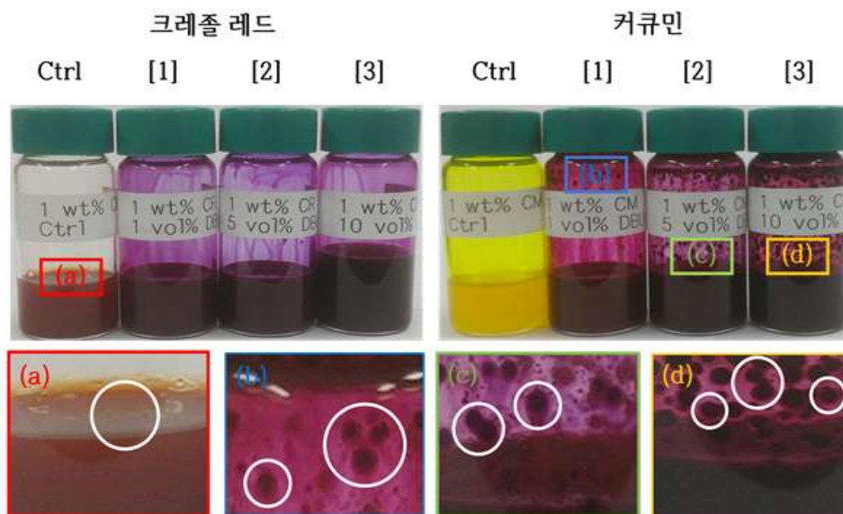
그림 29. 크레졸 레드, 커큐민의 DBU 함량에 따른 잉크 조성물의 외관 및 혼화성 평가
