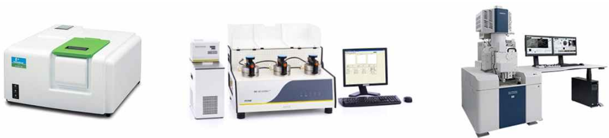
그림 14. 좌측부터 흡광 측정을 위한 UV-Vis 흡광계, 가스투과도 측정기, 레이저 가공 표면 확인을 위한 전자현미경 이미지
