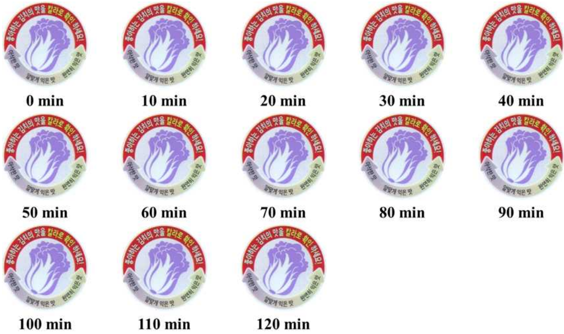
그림 145. 클로로 포름 노출에 따른 이산화탄소 감지 변색 결과: 좌측 상단 (최초) 에서부터 우측으로 10분 간격으로 최대 120분간 측정
