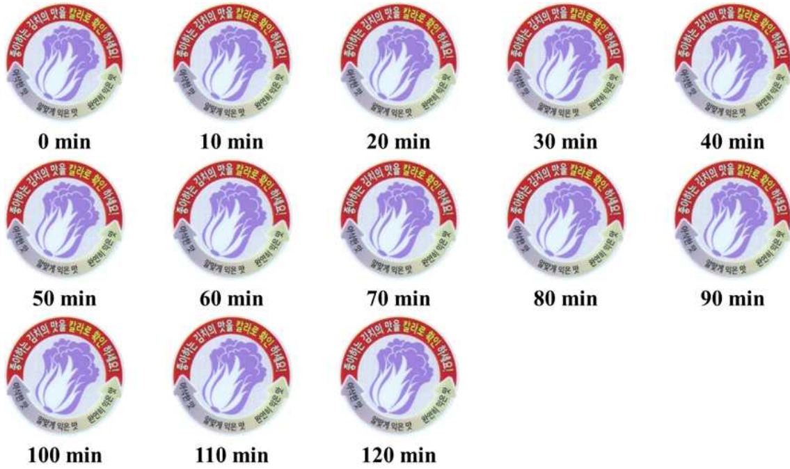
그림 147. 에틸 아세테이트 노출에 따른 이산화탄소 감지 변색 결과: 좌측 상단 (최초)에서부터 우측으로 10분 간격으로 최대 120분간 측정
