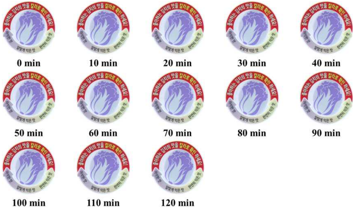
그림 126. pH 9 버퍼용액 노출 시, 시간에 따른 이산화탄소 감지 변색 결과: 좌측 상단 (최초) 에서부터 우측으로 10분 간격으로 최대 120분간 측정
