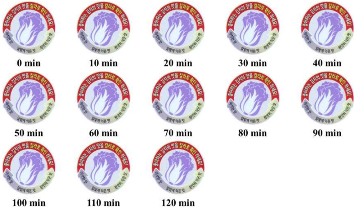
그림 141. 디메틸포름아마이드 노출에 따른 이산화탄소 감지 변색 결과: 좌측 상단 (최초)에서부터 우측으로 10분 간격으로 최대 120분간 측정
