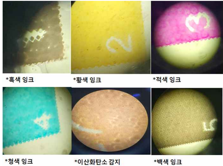
그림 15. 폴리우레탄 잉크 와 이산화탄소 감지 잉크 망점 측정
