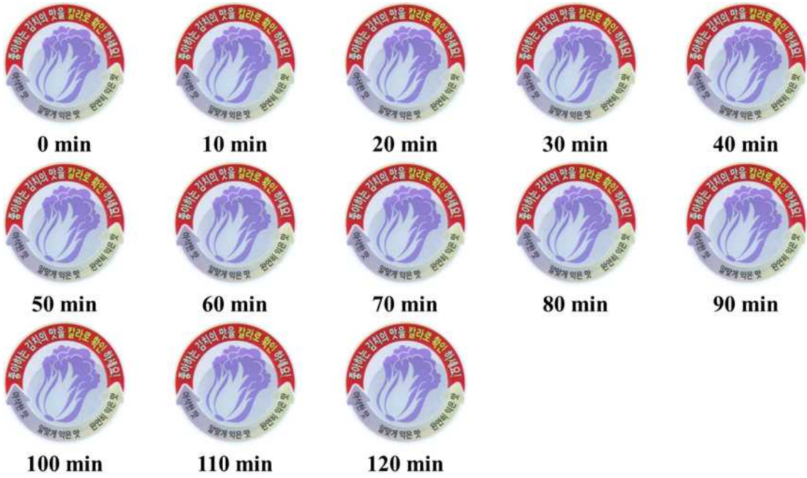
그림 128. pH 10 버퍼용액 노출 시, 시간에 따른 이산화탄소 감지 변색 결과: 좌측 상단 (최초) 에서부터 우측으로 10분 간격으로 최대 120분간 측정
