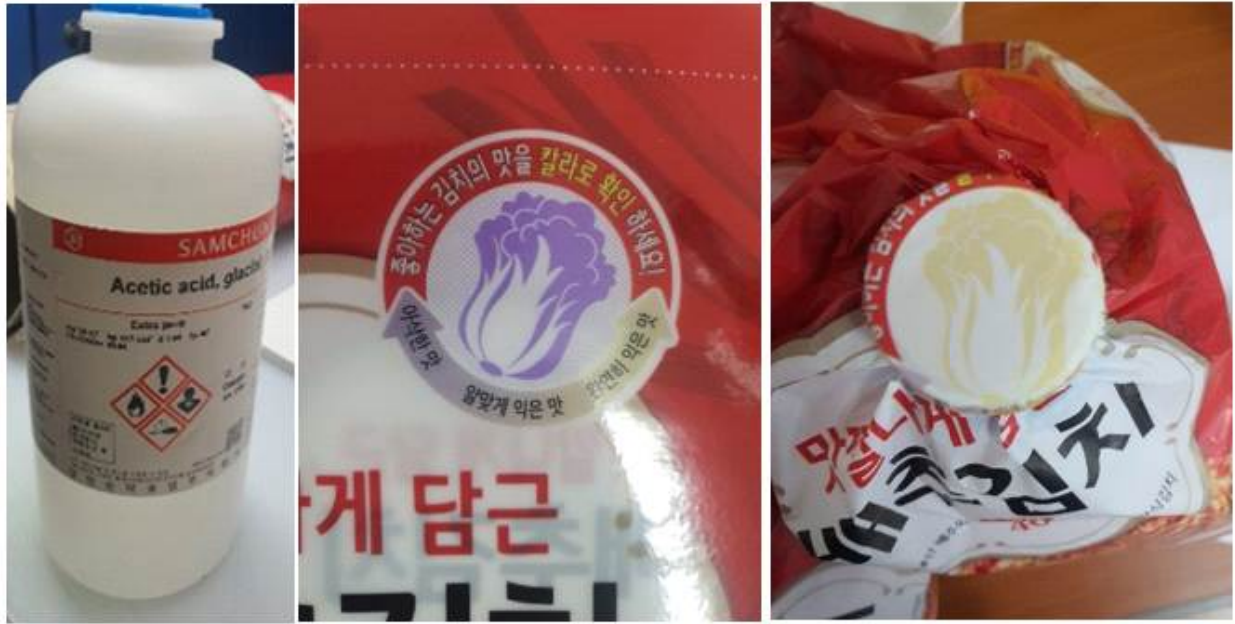
그림 92. Acetic acid 노출에 따른 Cresol Red 이산화탄소 감지 인쇄 및 합지 필름 색상변화 확인
