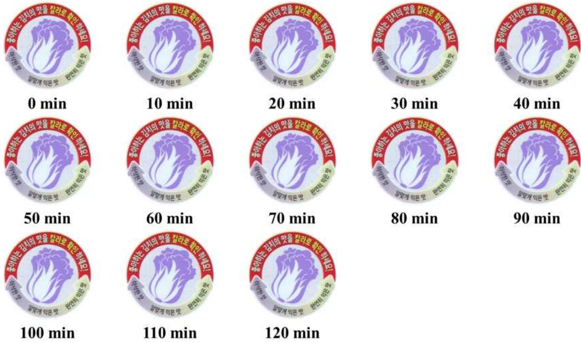
그림 151. 디클로로메테인 노출에 따른 이산화탄소 감지 변색 결과: 좌측 상단 (최초)에서부터 우측으로 10분 간격으로 최대 120분간 측정
