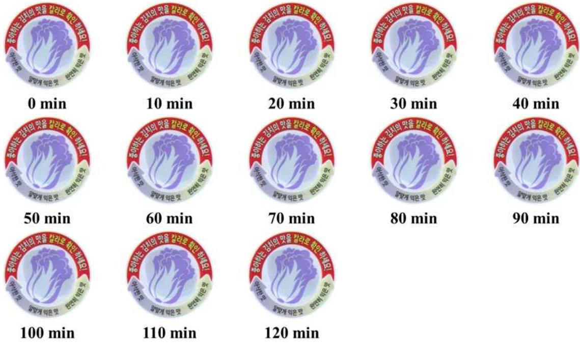
그림 130. pH 11 버퍼용액 노출 시, 시간에 따른 이산화탄소 감지 변색 결과: 좌측 상단 (최초) 에서부터 우측으로 10분 간격으로 최대 120분간 측정
