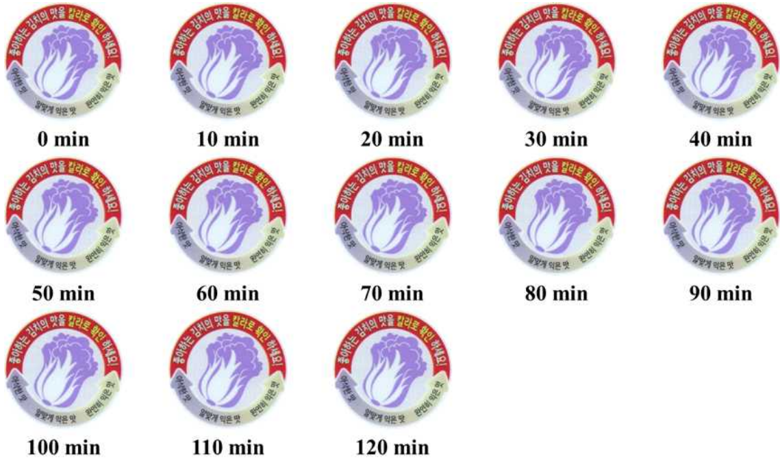
그림 143. 테트라하이드로푸란 노출에 따른 이산화탄소 감지 변색 결과: 좌측 상단 (최초)에서부터 우측으로 10분 간격으로 최대 120분간 측정
