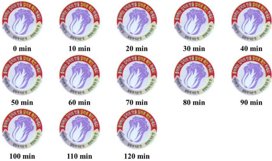
그림 161. 헥세인 노출에 따른 이산화탄소 감지 변색 결과: 좌측 상단 (최초) 에서부터 우측으로 10분 간격으로 최대 120분간 측정
