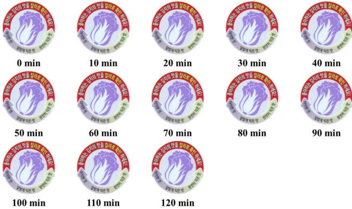
그림 155. 에틸 에터 노출에 따른 이산화탄소 감지 변색 결과: 좌측 상단 (최초) 에서부터 우측으로 10분 간격으로 최대 120분간 측정
