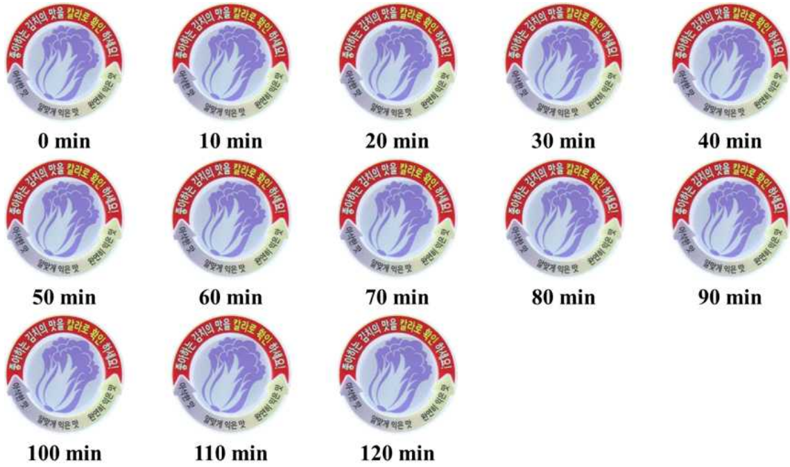
그림 134. pH 13 버퍼용액 노출 시, 시간에 따른 이산화탄소 감지 변색 결과: 좌측 상단 (최초) 에서부터 우측으로 10분 간격으로 최대 120분간 측정
