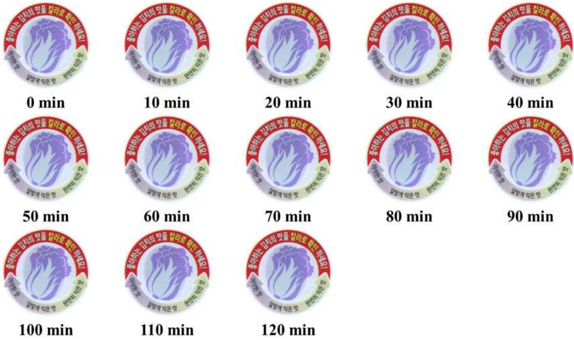
그림 116. pH 4 버퍼용액 노출 시, 시간에 따른 이산화탄소 감지 변색 결과: 좌측 상단 (최초) 에서부터 우측으로 10분 간격으로 최대 120분간 측정
