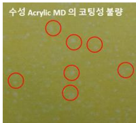
그림 106. 수성 Acrylic MD 에 대한 이산화탄소 감지 물질 코팅성 불량
