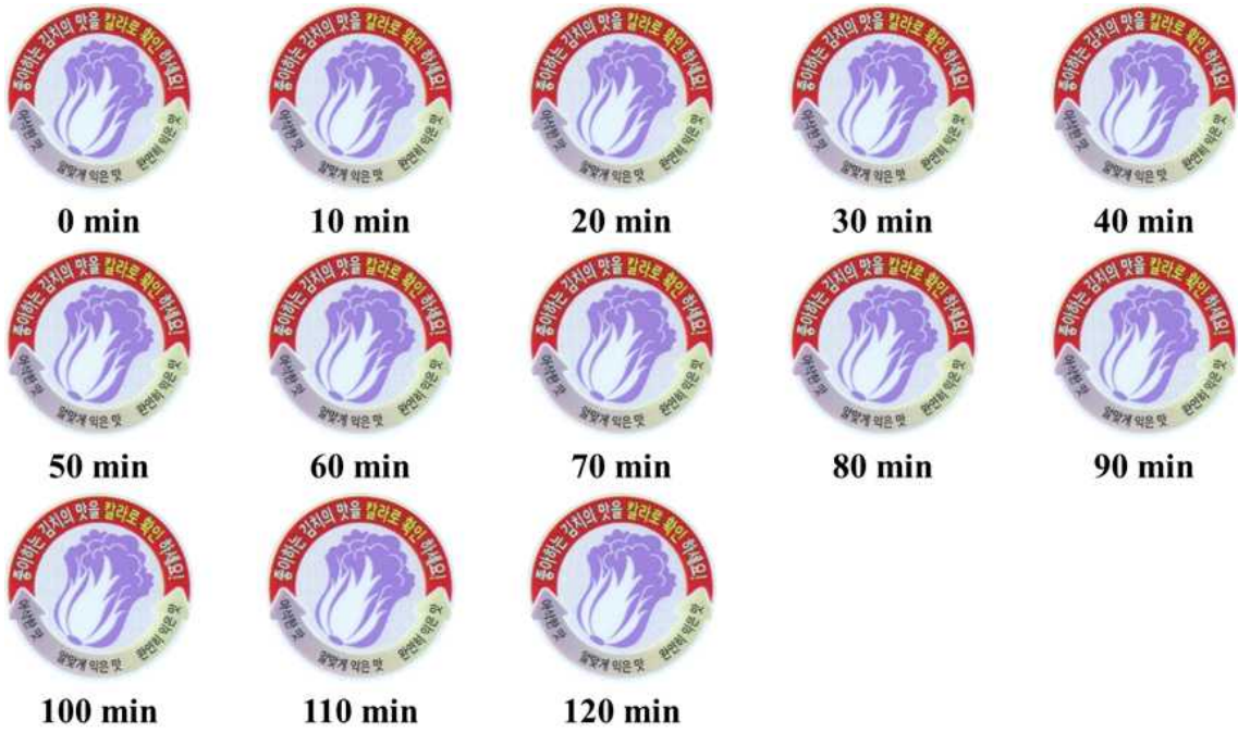
그림 153. 헥사 데케인 노출에 따른 이산화탄소 감지 변색 결과: 좌측 상단 (최초) 에서부터 우측으로 10분 간격으로 최대 120분간 측정
