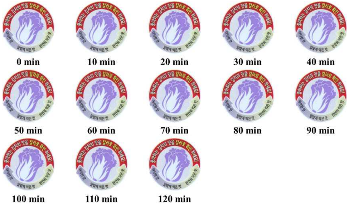
그림 159. 아세토나이트릴 노출에 따른 이산화탄소 감지 변색 결과: 좌측 상단 (최초)에서부터 우측으로 10분 간격으로 최대 120분간 측정
