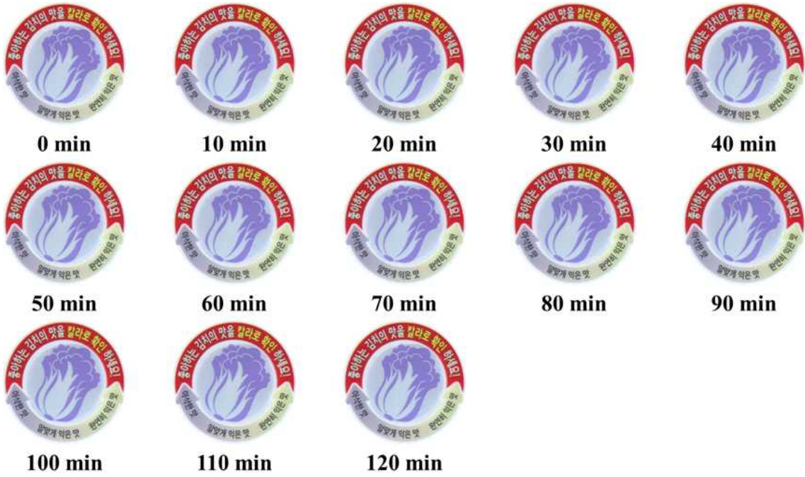
그림 120. pH 6 버퍼용액 노출 시, 시간에 따른 이산화탄소 감지 변색 결과: 좌측 상단 (최초) 에서부터 우측으로 10분 간격으로 최대 120분간 측정
