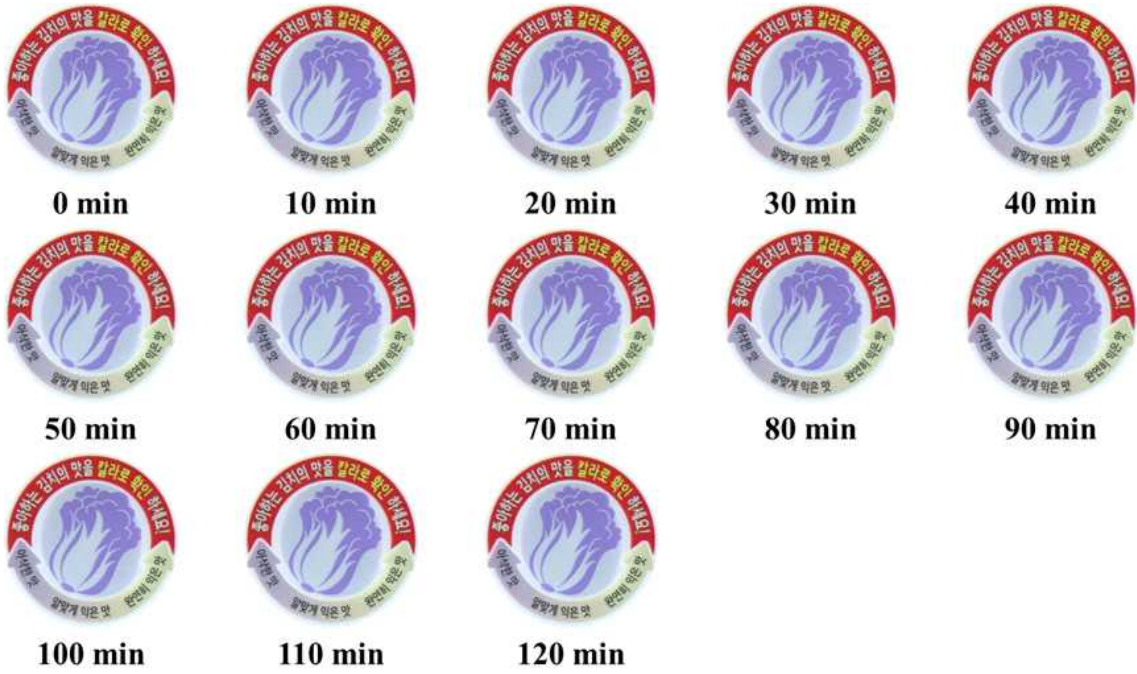
그림 118. pH 5 버퍼용액 노출 시, 시간에 따른 이산화탄소 감지 변색 결과: 좌측 상단 (최초) 에서부터 우측으로 10분 간격으로 최대 120분간 측정
