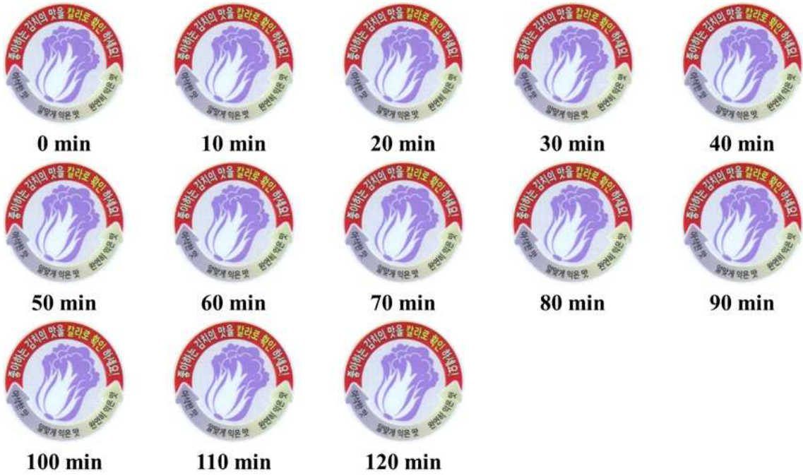
그림 157. 사이클로 헥세인 노출에 따른 이산화탄소 감지 변색 결과: 좌측 상단 (최초)에서부터 우측으로 10분 간격으로 최대 120분간 측정
