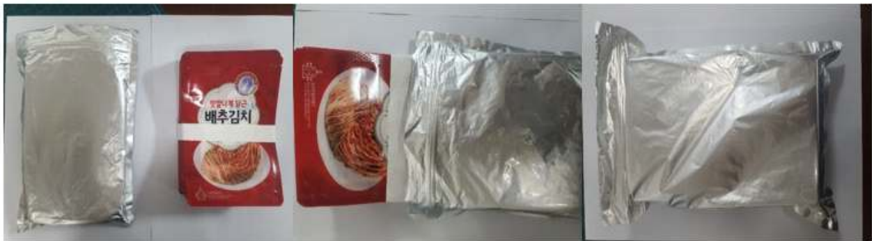
그림 93. 최종 Cresol Red 이산화탄소 감지 김치 파우치 제작
