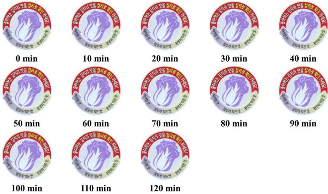
그림 149. 톨루엔 노출에 따른 이산화탄소 감지 변색 결과: 좌측 상단 (최초) 에서부터 우측으로 10분 간격으로 최대 120분간 측정
