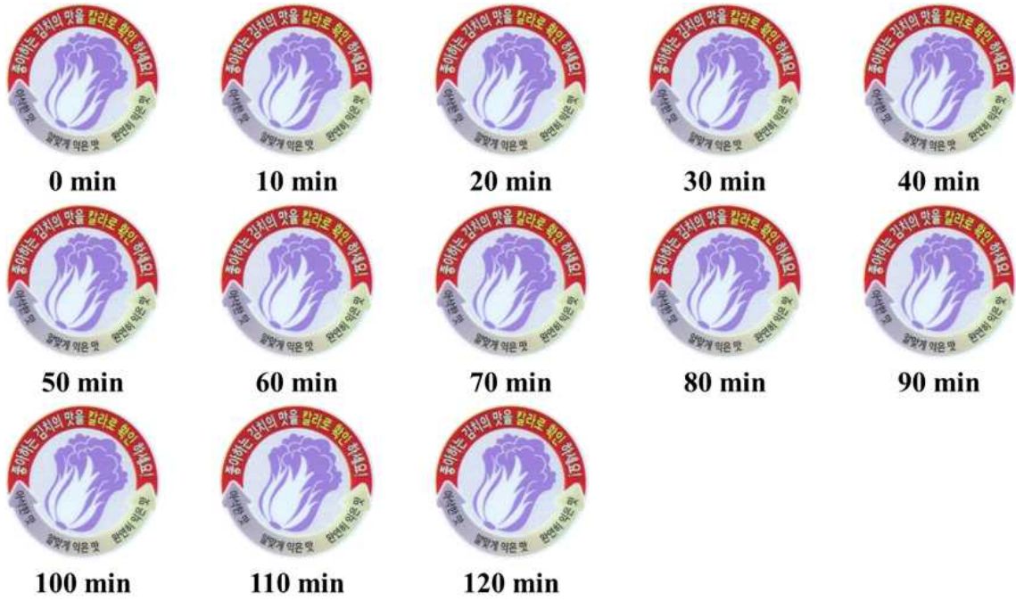
그림 139. 메틸에틸케톤 노출에 따른 이산화탄소 감지 변색 결과: 좌측 상단 (최초) 에서부터 우측으로 10분 간격으로 최대 120분간 측정
