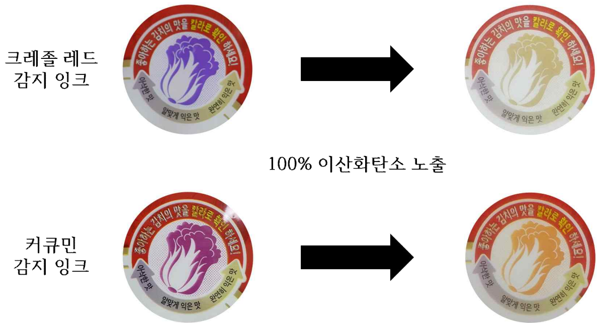
그림 66. 김치포장지에 적용된 각각의 감지 잉크에 대한 100% 이산화탄소 노출 전후에 따른 변색
