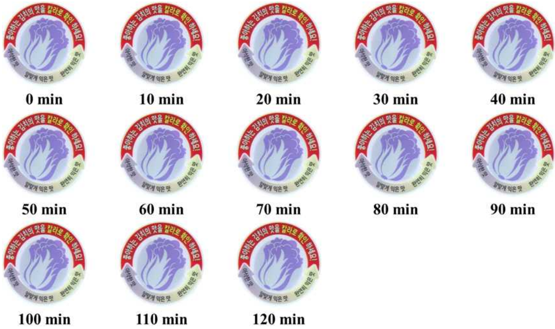
그림 110. pH 1 버퍼용액 노출 시, 시간에 따른 이산화탄소 감지 변색 결과: 좌측 상단 (최초)에서부터 우측으로 10분 간격으로 최대 120분간 측정
