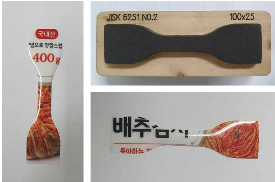
그림 163. 김치 숙성도 감지 포장 필름의 기계적 물성 평가를 위한 샘플 및 제조 몰드
