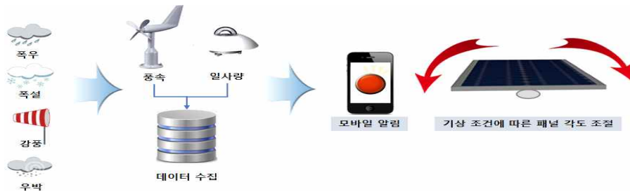
그림 17. 기상 및 환경 모니터링을 통한 알림 기능 및 태양광 발전용 모듈 가변 시스템 개발 예시.
