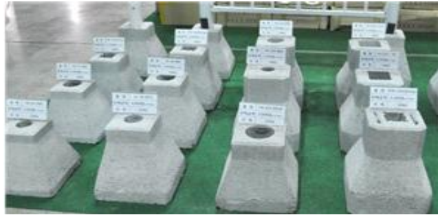
그림 13. 한국형 태양광 이모작용 개발 기초 시공법 및 보강재 예시 ; (a) 나사말뚝 및 (b) 기초 보강재.
