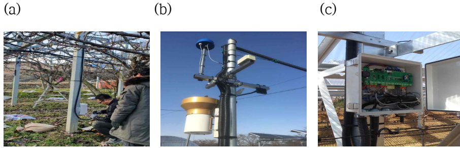
그림 108. 한국형 태양광 이모작용 계측 센서 구축 모습;
