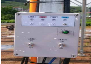
그림 89. 농업용 액상 살포시스템의 수동 스케줄링 장치.
