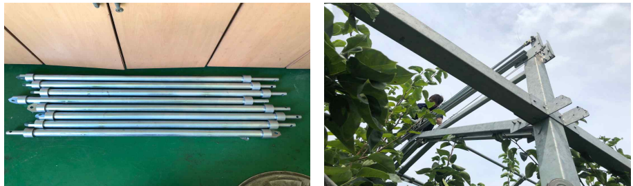
그림 63. 배 전용 접이식 구조물의 와이어텐션 조절장치 개발 및 적용 모습.
