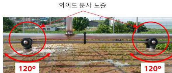
그림 85. 농업용 액상 살포시스템용 와이드 분사 노즐 개발 모습.
