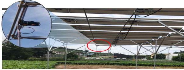
그림 86. 농업용 액상 살포시스템용 와이드 분사 노즐 구동장치 모습
