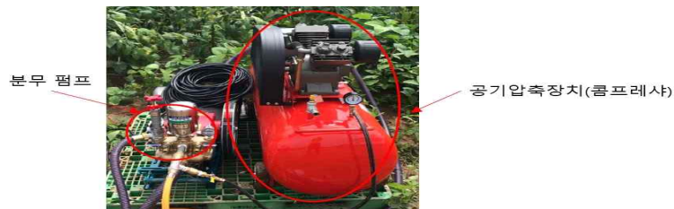
그림 87. 농업용 액상 살포시스템용 유지보수를 위한 액상살포 보조 장치 모습.
