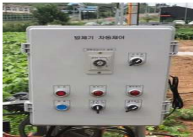
그림 90. 농업용 액상 살포시스템의 자동 스케줄링 장치.
