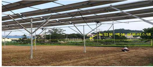
그림 84. 10kW급 태양광 이모작 밭 실증단지에 적용된 농업용 액상 살포시스템 모습.
