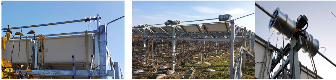
그림 64. 배 과수 전용 접이식 구조물 구동부 개선 모습;
