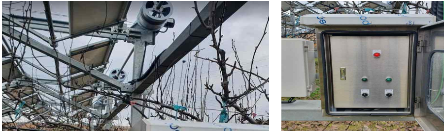
그림 94. 배 과수용 접이식 구조물 구동장치 및 제어기.
