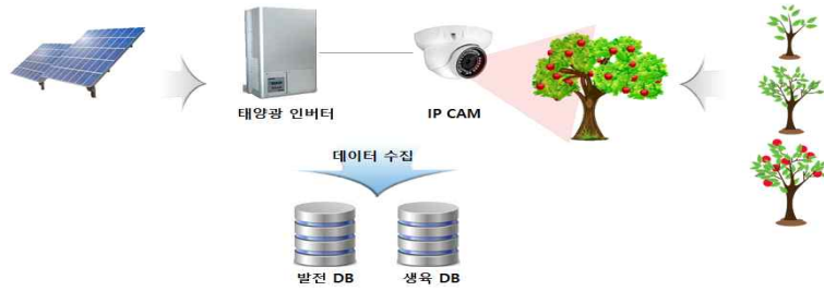
그림 16. 한국형 태양광 이모작 시스템을 이용한 농작물 실시간 모니터링 및 DB 구축 예시.
