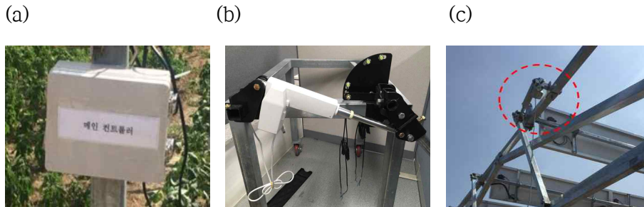
그림 91. 한국형 태양광 이모작용 태양광 발전용 모듈 트래킹 제어 기술 개발; (A) 메인 컨트롤러, (B) 각도 가변형 액츄에이터 및 (C) 각도 제어 장치 결합 모습.
