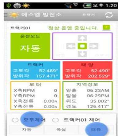
그림 9. 태양광 발전용 모듈 트래킹 제어 소프트웨어 및 개발 어플리케이션.
