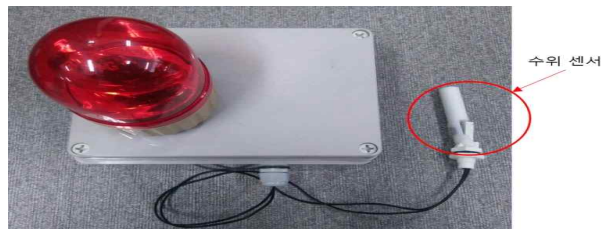
그림 88. 농업용 액상 살포시스템 저장탱크 수위 알림 기능 센서.
