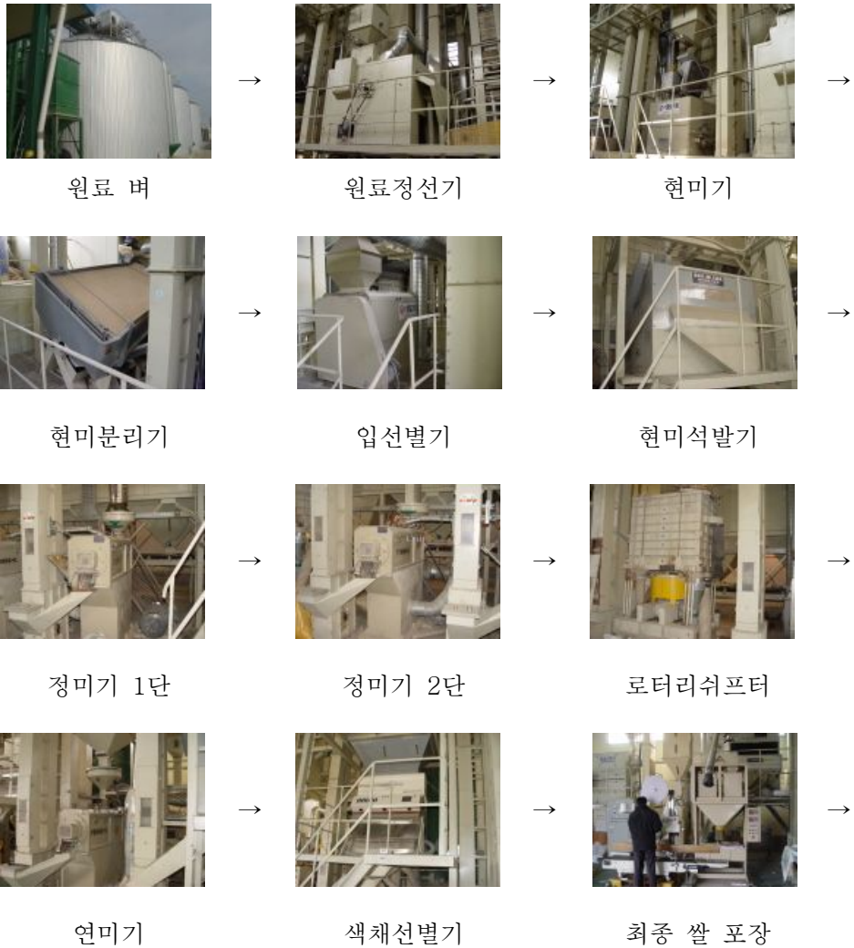
Fig. 3-50. 성능분석 RPC의 주요 가공공정 (RPC별 단위기계 및 운영방법은 다소 다름)
