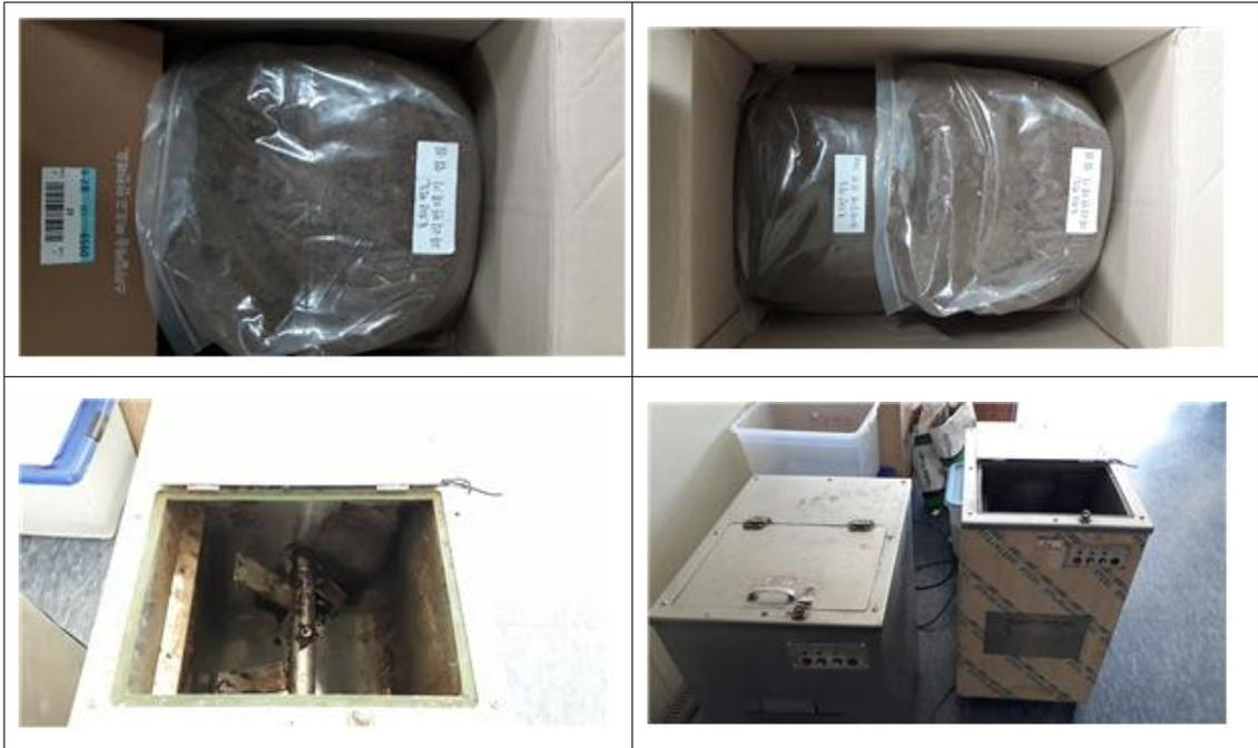
그림. 방선균, 유산균, 광합성균 3종을 이용한 호기발효 교반기 및 발효산물
