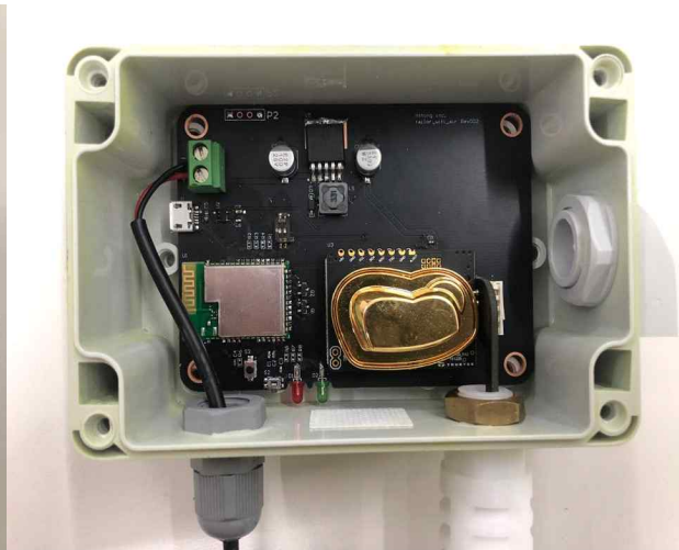
[게이트웨이 통합형 무선 대기 센서 모듈 시제품(좌) 및 내부 PCB 구성(우)]
