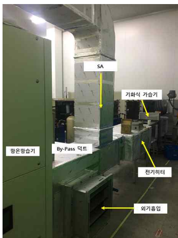
(a) 기화식 가습기 평가장비 (b) 기화식가습 소자 설치 (c) 기화식 가습기 급수라인 [기화식 가습소자 현열부하 처리 평가장치]
