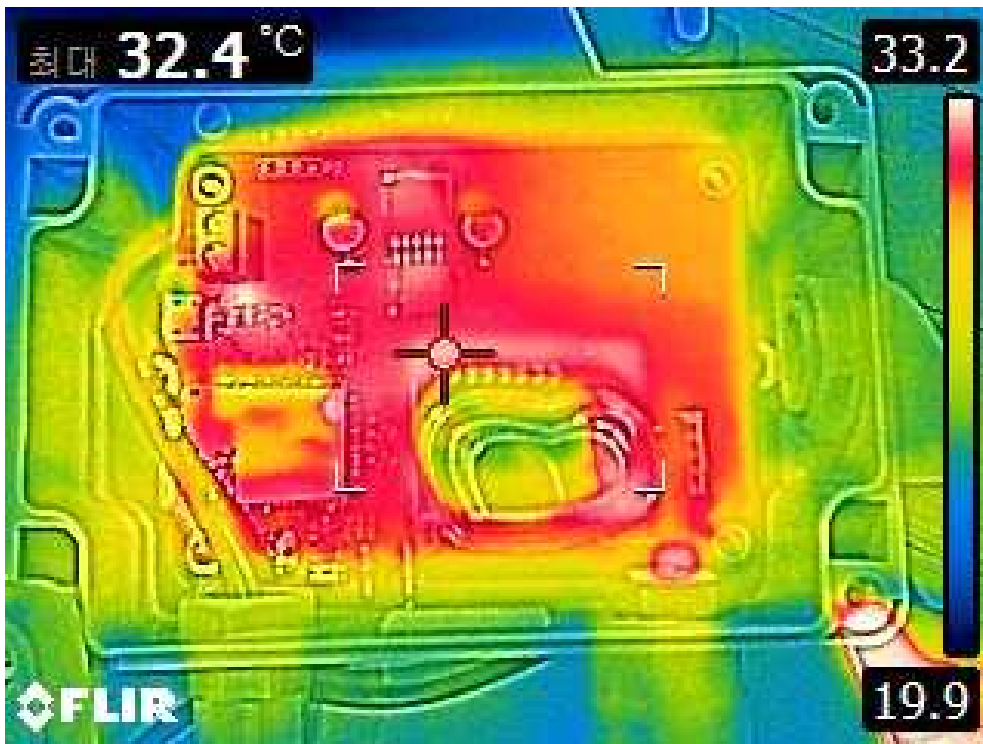
[게이트웨이 통합형 무선 대기 센서 모듈 저전력 설계 발열 테스트]
