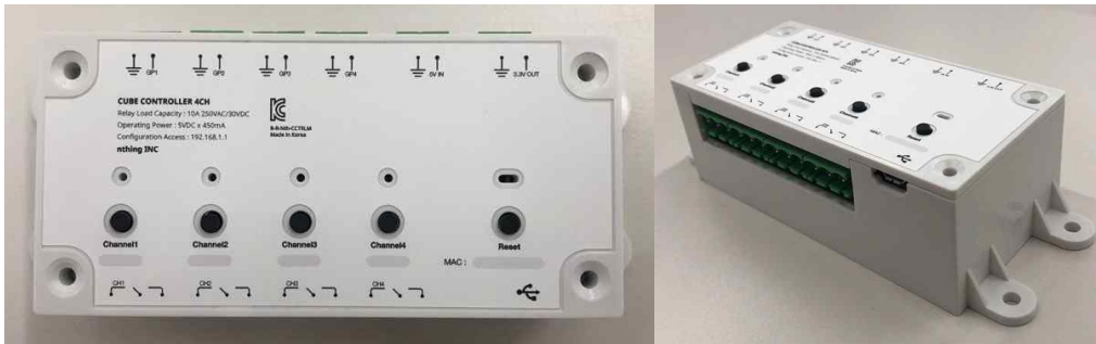
[무선 재배기 다중 컨트롤 디바이스 및 동작감지 센서 모듈 시작품]
