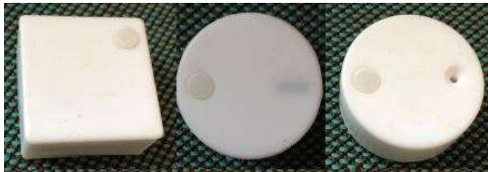
그림 136 무선온도(좌), 조도(중앙), 습도(우) 센서
