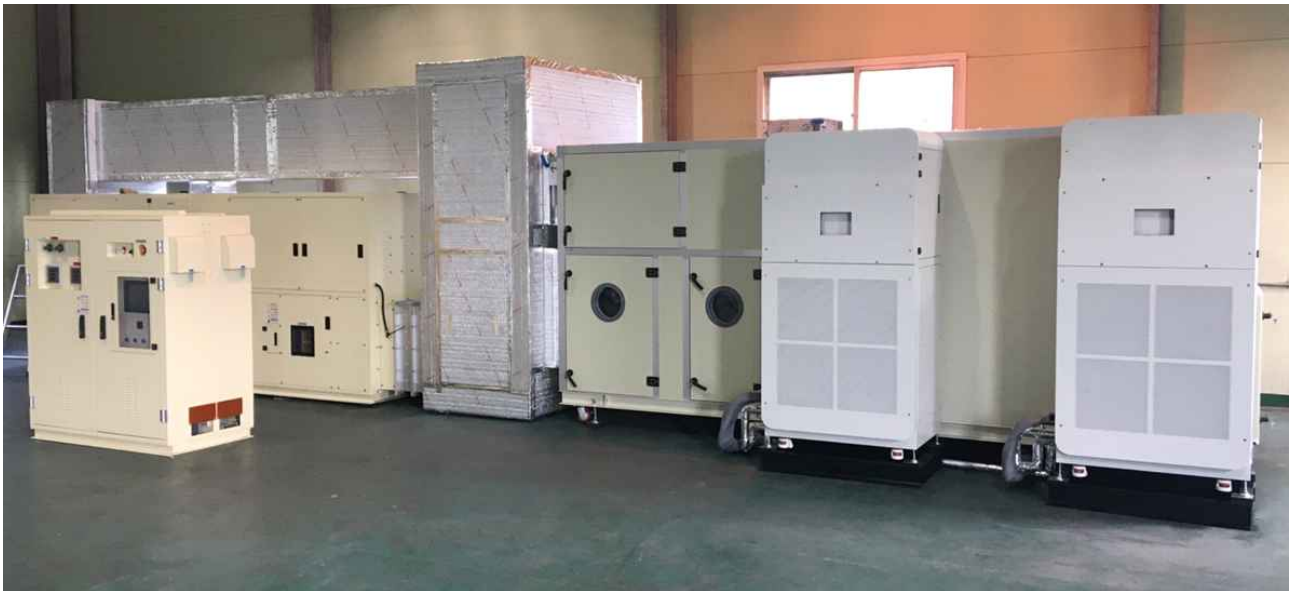
(b) 평가장비 실제 구성 사진 [항온항습기 실증 평가장비 구성]
