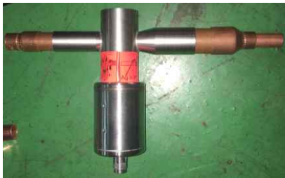
(a) 2way valve 설치 전
