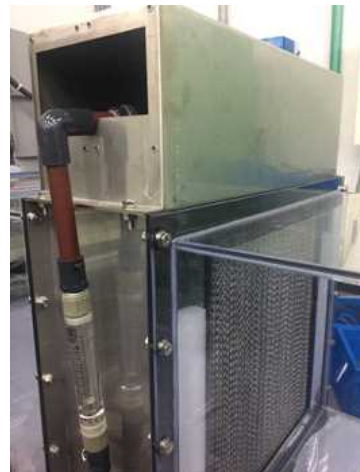
(a) 기화식 가습기 평가장비 (b) 기화식가습 소자 설치 (c) 기화식 가습기 급수라인 [기화식 가습소자 현열부하 처리 평가장치]
