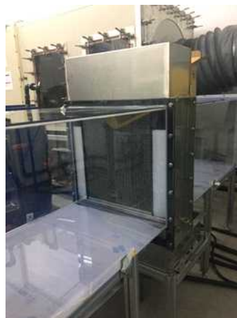
(a) 기화식 가습기 평가장비 (b) 기화식가습 소자 설치 (c) 기화식 가습기 급수라인 [기화식 가습소자 현열부하 처리 평가장치]
