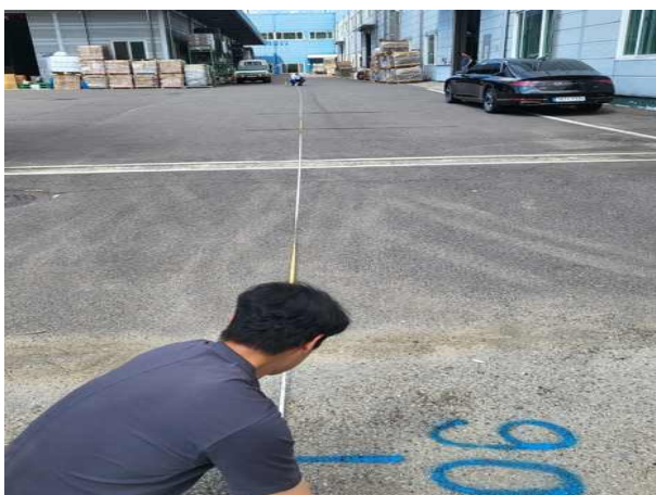
[그림] 승용제초기 원격 통신 거리 측정 시험 모습
