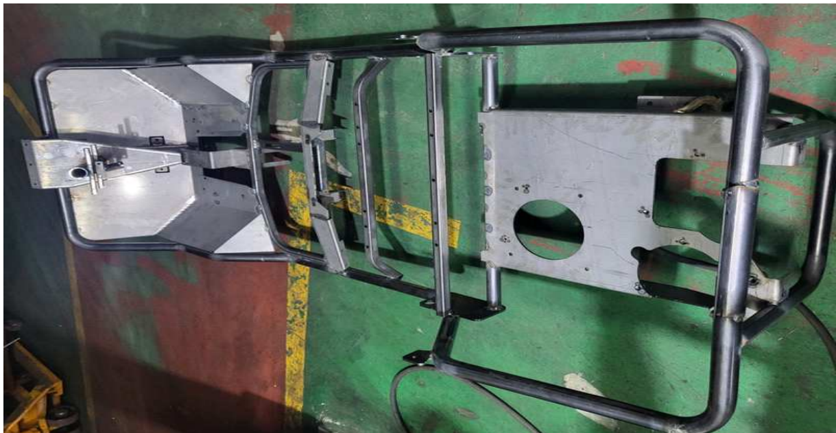
[그림] 제초 프레임 제작모습
