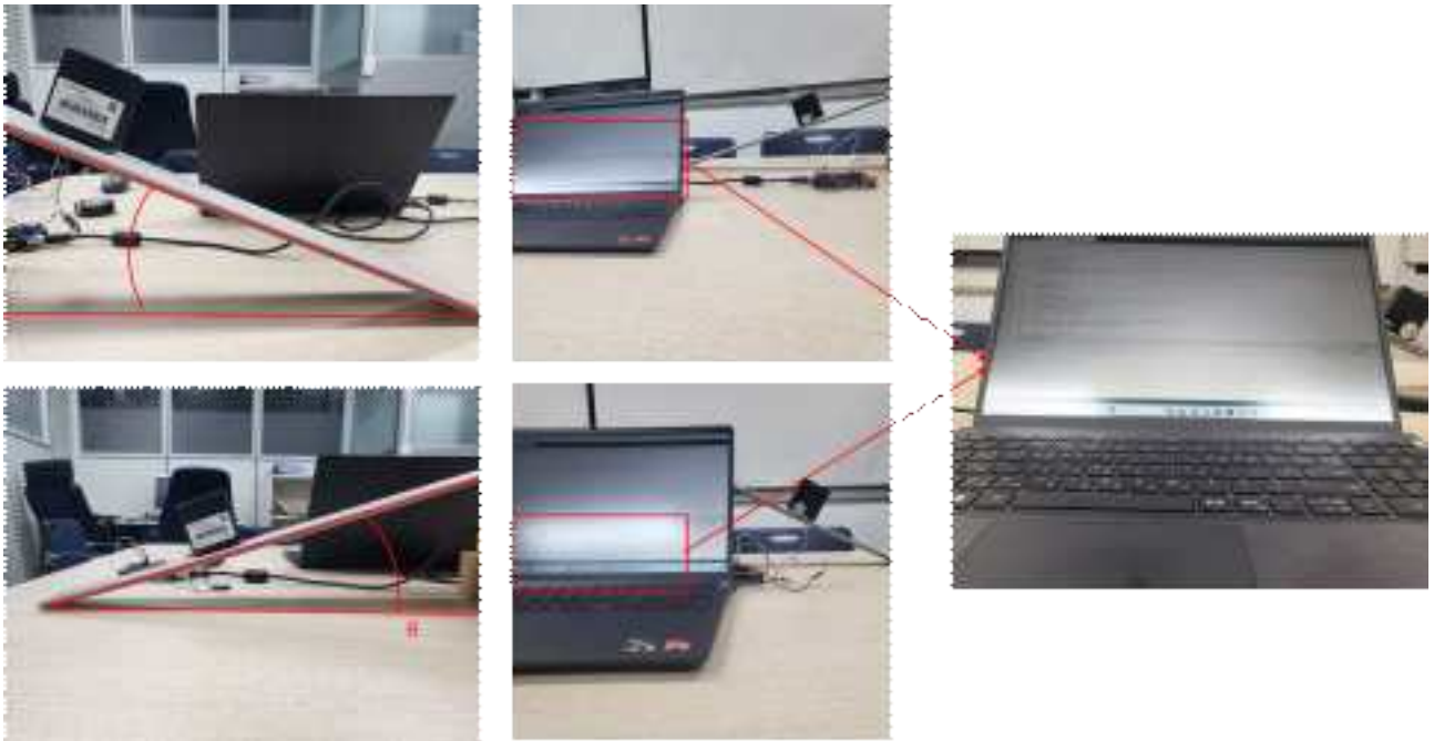
[그림] 경사 감지 시스템 기울기 측정 모듈 각도 측정 테스트
