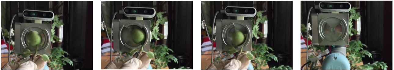
<원통형 회전 절단 방식의 적과용 엔드이펙터(EE) 제작>
