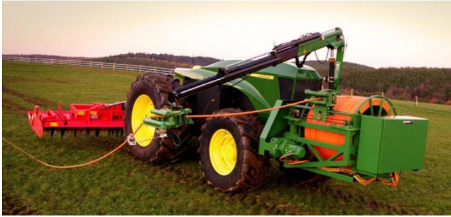
<John deere 社の Plug-in 타입 전기구동 트랙터(GridCON)>
