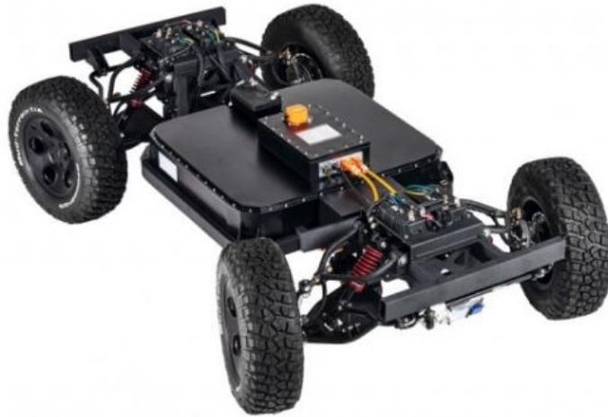
<모헤닉모터스 社の 인휠모터 시스템 적용 차량>
