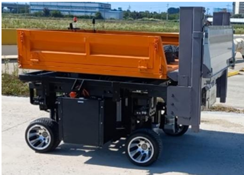
<적재.하역을 위한 리프트 시스템 및 안전사고 예방을 위한 비상정지 버튼>
