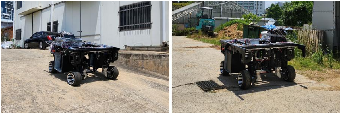
<전기구동 플랫폼의 등판·강판주행 및 평지주행 테스트>
