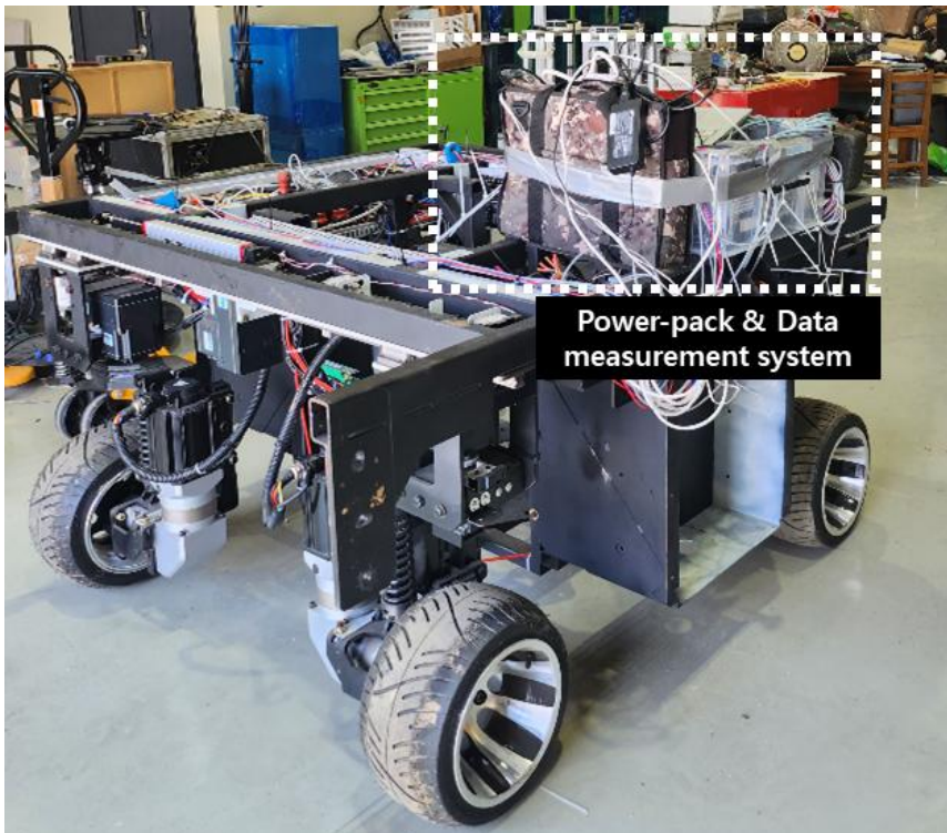
<성능 측정을 위한 독립 전기구동 플랫폼 및 데이터 계측 시스템>
