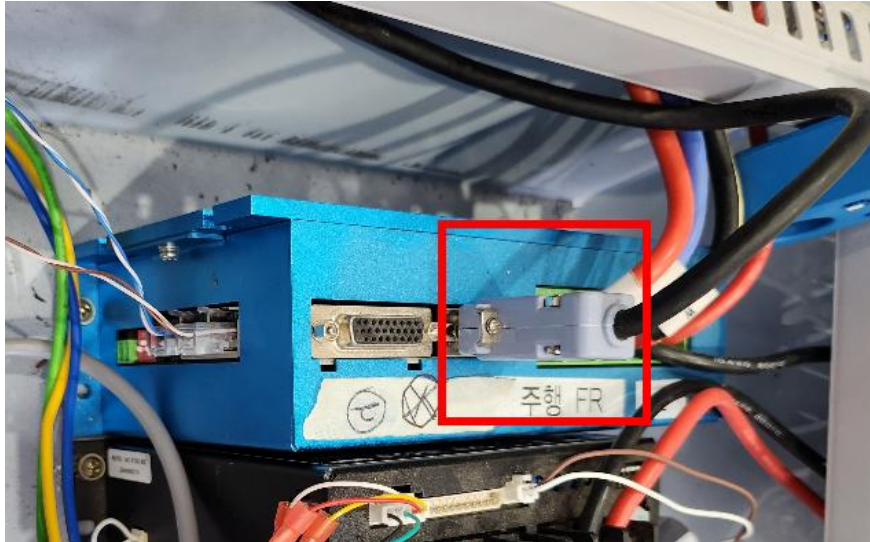
<모터 인버터의 실시간 CAN 데이터 측정을 위한 시스템 구성>
