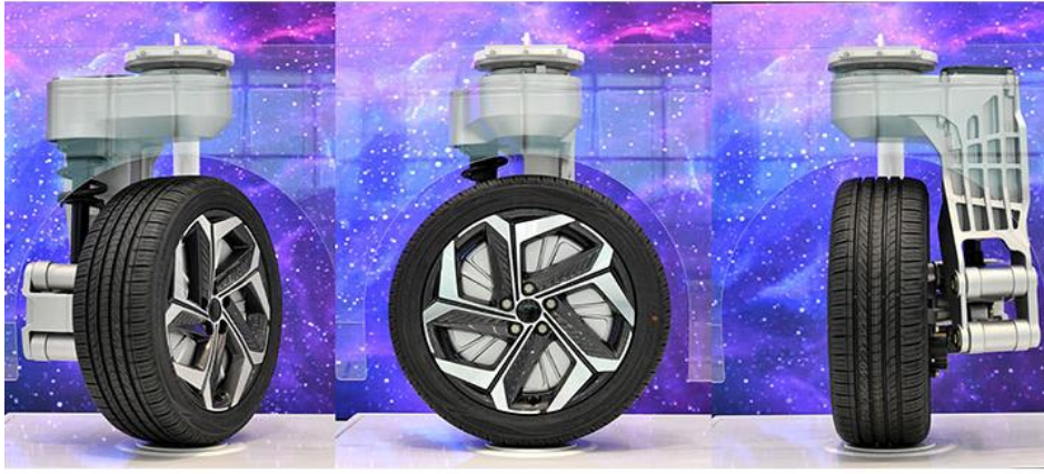
<현대모비스 社の 전기모터 기반 독립 구동 시스템 (e-Corner 모듈)>
