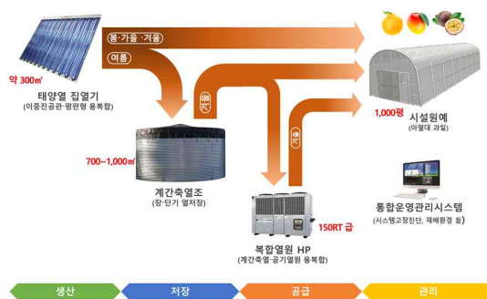
[그림 1-2] 실증 시설원에 태양열 계간축열기반 열공급 시스템 구성도
