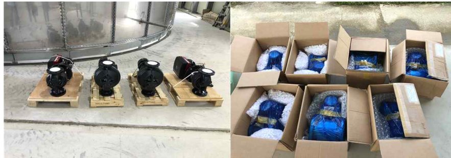
[그림 4-68] 실증시스템 적용 인버터 펌프 및 유량계
