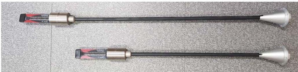
(a) 변형 센서 및 토양 수분 함량 센서
