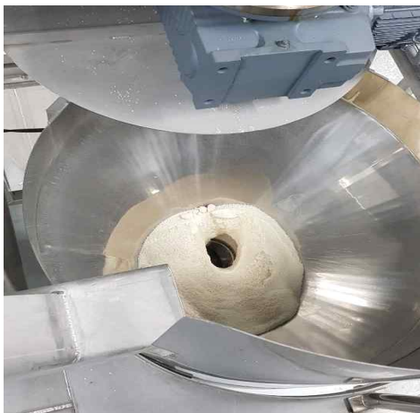
가수 후 쌀이 제분공정으로 이동하는 공정에서 적체되어 이송되지 않는 모습
