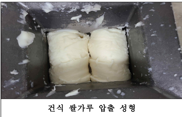
<그림 2-6>. 가래떡 제조 주요 공정과 발생 현상
