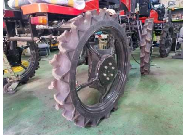
《 승용관리기 습지용 차륜의 개량개선 전(좌측)·후(우측) 사진 》
