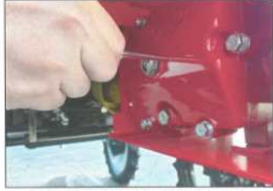
Fig. 2 제일 분무기 크랭크 Y축 진동 측정.
