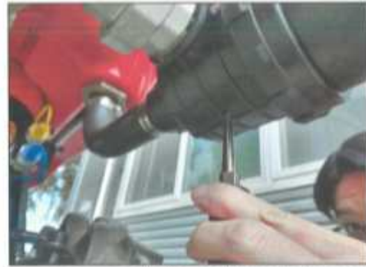
Fig. 12 해청 분무기-개발 흡입필터 Z축 진동 측정.
