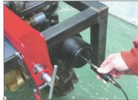
Fig. 16 해청 분무기-개발 흡입필터 X축 진동 측정.
