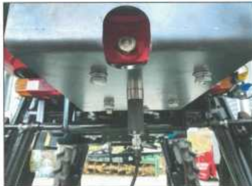
Fig. 15 해청 분무기-개발 크랭크 Z축 진동 측정.
