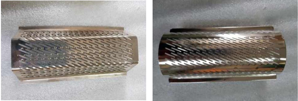
《 도정기 금망형상의 개량개선 전(육각: 좌측) · 후(원형: 우측) 사진 》
