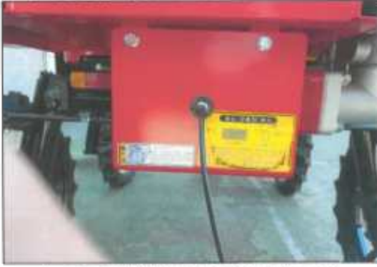
Fig. 1 제일 분무기 크랭크 X축 진동 측정.
