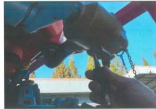
Fig. 6 제일 분무기 흡입필터 Z축 진동 측정.
