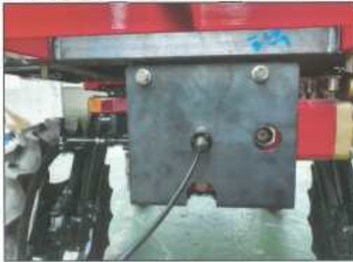
Fig. 13 해청 분무기-개발 크랭크 X축 진동 측정.
