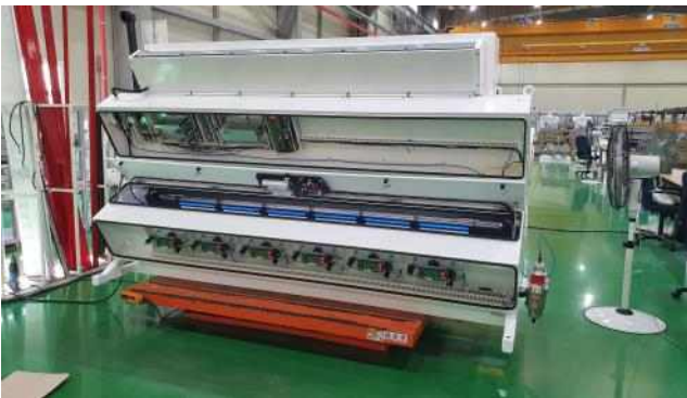
전기 배선 및 전장품 조립 공정
