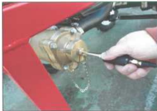
Fig. 5 제일 분무기 흡입필터 Y축 진동 측정.
