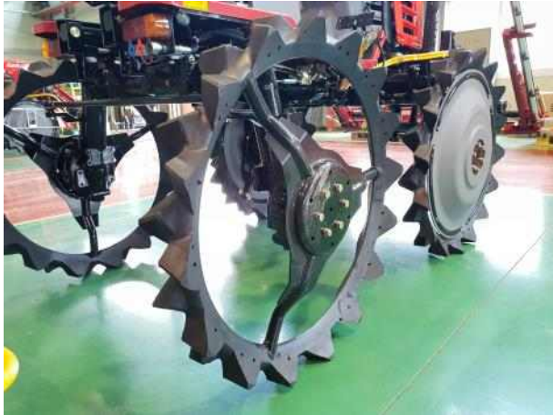
《 승용관리기 습지용 차륜의 개량개선 전(좌측)·후(우측) 사진 》
