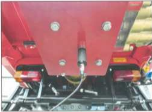
Fig. 9 해청 분무기-개발 크랭크 Z축 진동 측정.
