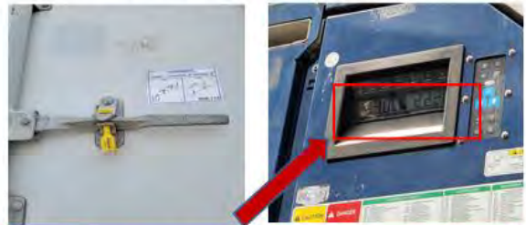
<그림3-24> 컨테이너 Sealing 및 내부온도(19°C) 세팅
