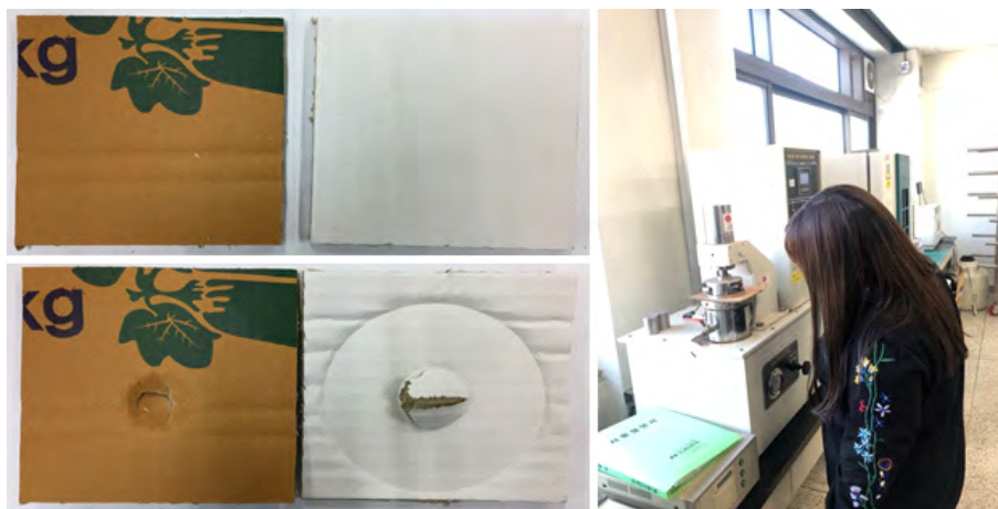
그림 6. 골판지 상자의 파열강도 시험 이미지 (좌: 실험전후 시편변화, 우: 시험 장비 가동 시 이미지)
