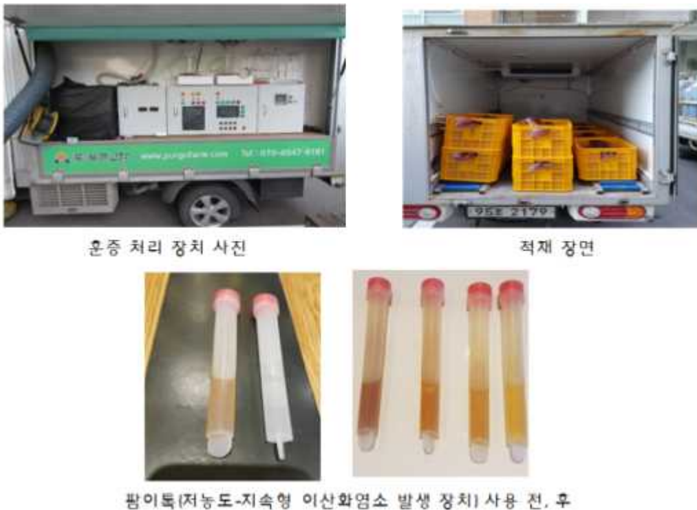
그림 2. 이산화염소 전처리 장비(상) 및 저농도-지속형 스틱 제형(하)
