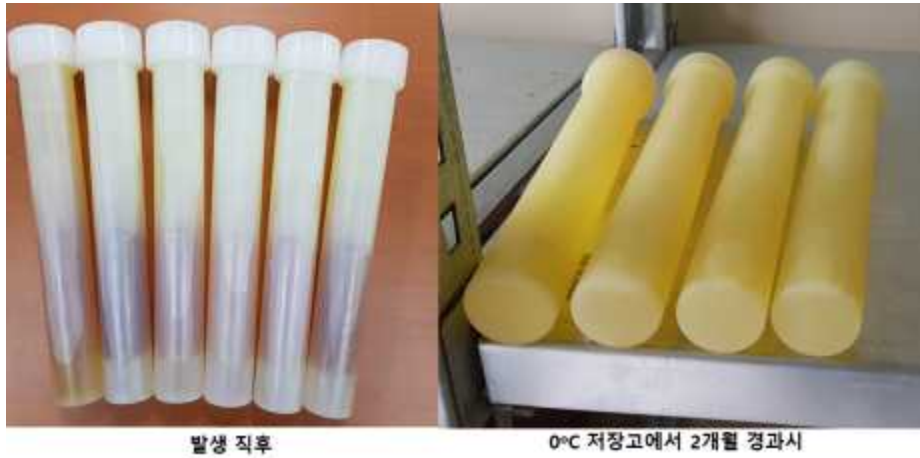
<점보스틱 이산화염소 발생직후 모습 및 2개월 경과시 점보스틱 색변화> 아직 이산화염소가 방출되고 있음
