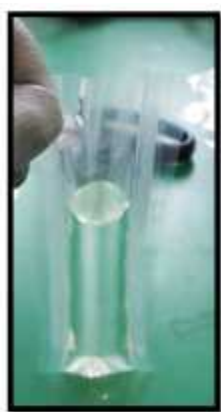
PE재질의 락에 B수용액 50ml 채움. 락 입구는 밀봉하지 않고 뒤집으면 용액이 쏟아져 반응하도록 하였음.
