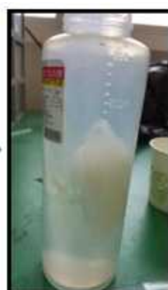
실리카겔에 의한 가스 방출량 차이를 비교 실험 하기 위해 한쪽에는 실리카겔을 20g PE 락에 담아 밀봉하여 넣었음.
