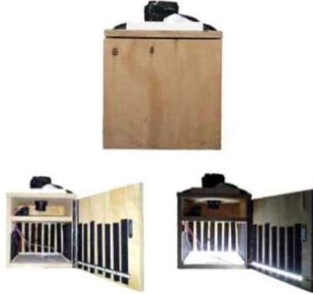
[그림 17. 표준화된 상태에서 사진 획득하기 위한 Image capture box]
