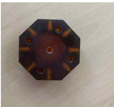
그림 27. 제작된 식품 잔류농약 측정 시스템의 멀티 밸브(좌)와 유로를 바꿔주는 역할을 하는 내부 구조물
