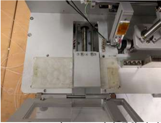
그림 97, 98. 작된 통합 유전자 분석기기의 추출용 자석의 착탈
