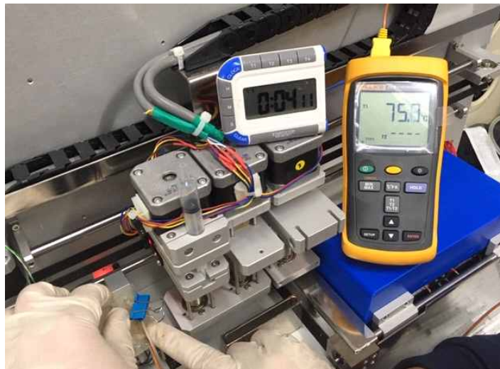
그림 122. Lysis chamber 가열온도 테스트
