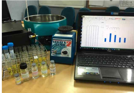
그림 19. 초기 효소저해법 매뉴얼 방식 테스트 사진(자체 412nm)
