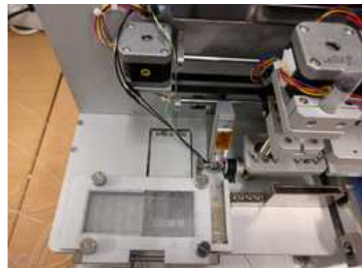
그림 101, 102. 제작된 통합 유전자 분석기기의 추출용 히터의 칩과의 접촉(좌) 및 분리(우)
