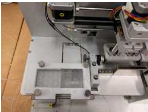
그림 101, 102. 제작된 통합 유전자 분석기기의 추출용 히터의 칩과의 접촉(좌) 및 분리(우)
