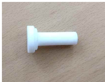
그림 27. 제작된 식품 잔류농약 측정 시스템의 멀티 밸브(좌)와 유로를 바꿔주는 역할을 하는 내부 구조물
