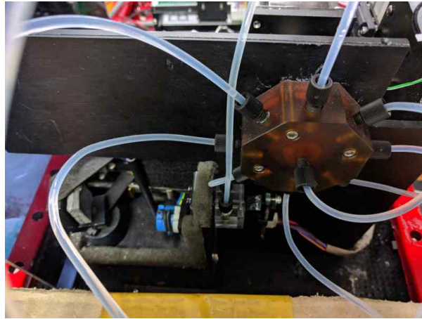
그림 24. 제작된 식품 잔류농약 측정 시스템의 분광광학계 및 멀티밸브
