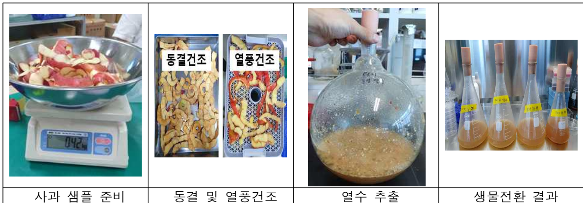
결과13. 원산지별로 구매한 사과의 과피를 벗겨 실험 재료로 사용하기 위한 시료 전처리 과정
