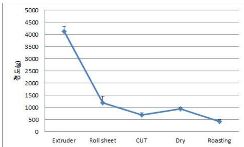
그림 55. 현미칩 최적 제조 공정별 시료의 경도 변화
