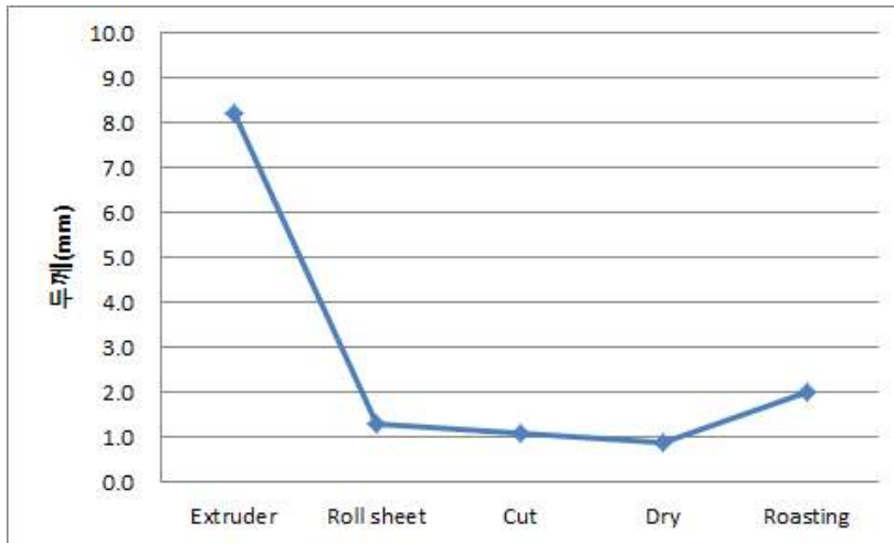
그림 57. 현미칩 최적 제조 공정별 시료의 두께 변화
