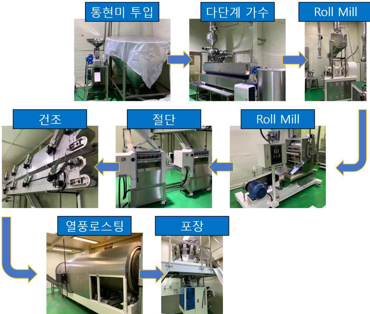
그림 97. 통현미를 이용한 현미스낵의 산업용 제조과정
