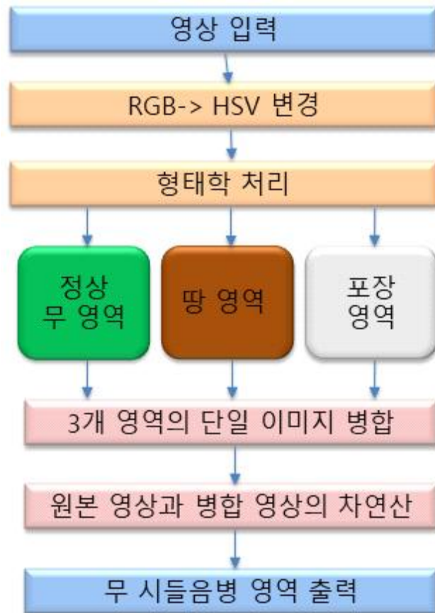
그림 97. HSV기반 영역 추출 소프트웨어 시스템 흐름도
