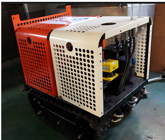
[그림 23] 테스트용 데모 차량 모델링과 1/5 데모 차량 제작
