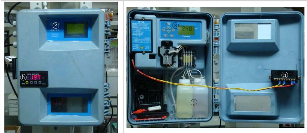
[그림. 3-72] 잔류염소량 측정 및 디스플레이 장치
