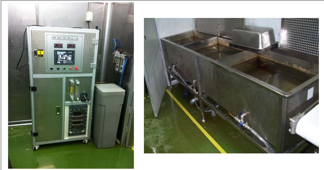
[그림. 3-78] 현장설치된 복합 살균소독장치 및 세척조
