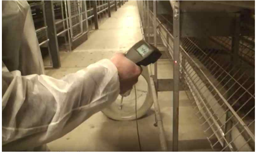
그림 3-23 열소독시 프레임온도가 45도 이상 유지되어야 한다.
