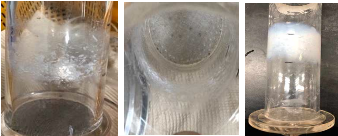
<그림 13> 생석회 처리로 인한 아크릴 용기 변형
