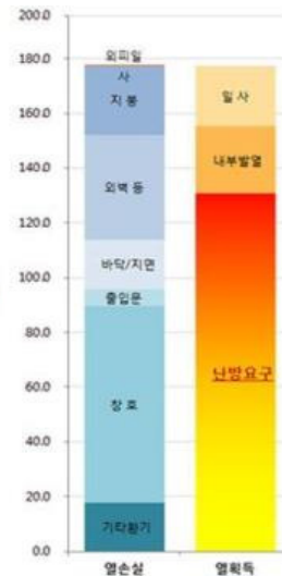
<그림 41> 후동2리 마을회관 에너지 시뮬레이션 결과
