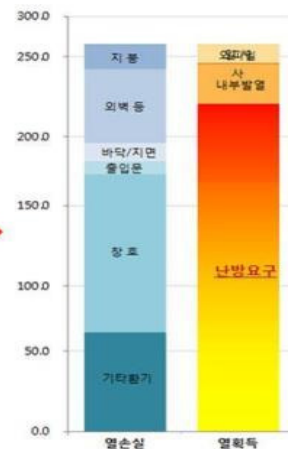
<그림 40> 월송3리 마을회관 에너지 시뮬레이션 결과
