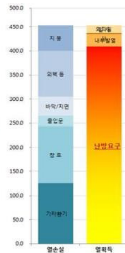
<그림 42> 유촌리 경로당 에너지 시뮬레이션 결과
