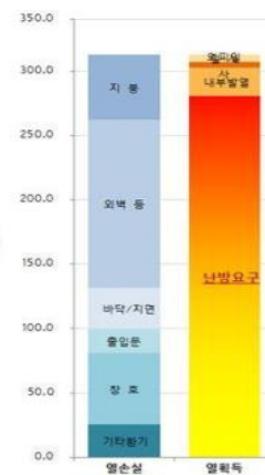
<그림 44> 대농 경로당 에너지 시뮬레이션 결과
