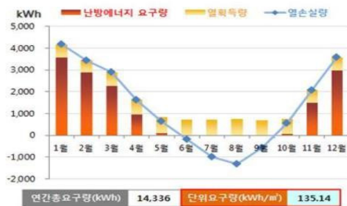
<그림 48> 옥적리 마을회관 에너지 시뮬레이션 결과
