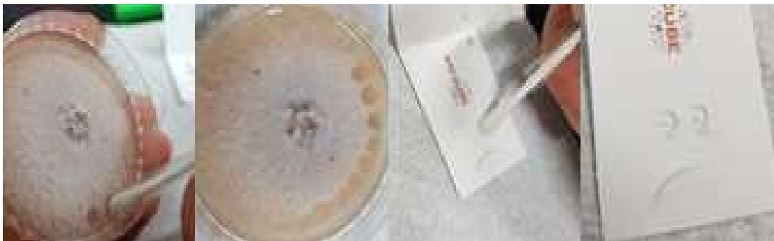
그림 155. 곰팡이 추출에 면봉을 사용한 바이오큐브 적용방법
