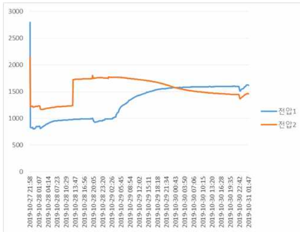
그림8. 신소재센서2개의 반복시험 데이터이며, 장력센서와 수분함량센서를 함께 사용했음
