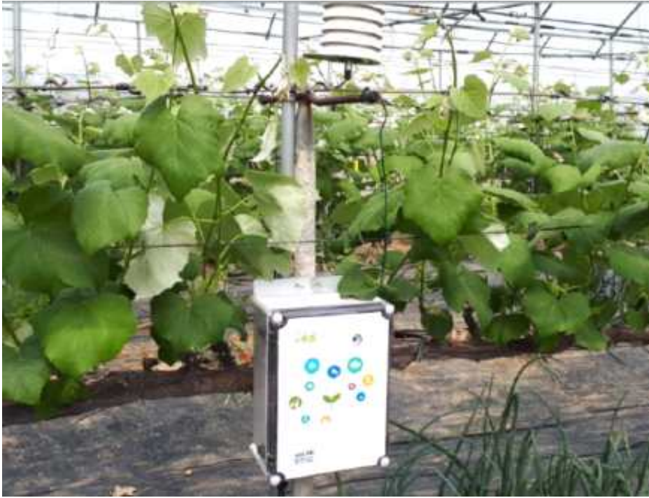
<설치 완료 된 센서 노드>
