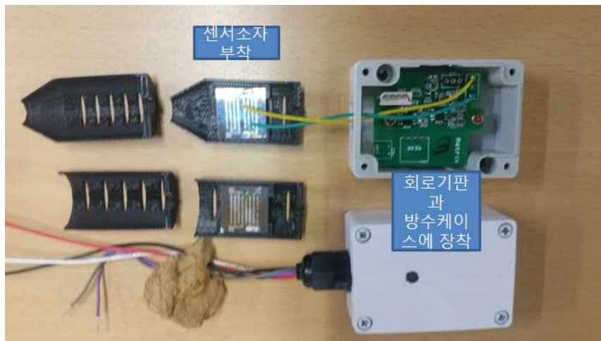
사진8. 소재와 회로부의 조립
