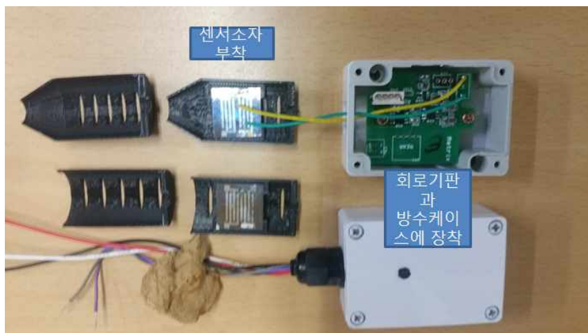
< 그림4 모듈케이스에 개발센서소자 부착 및 회로보드 결합 >
