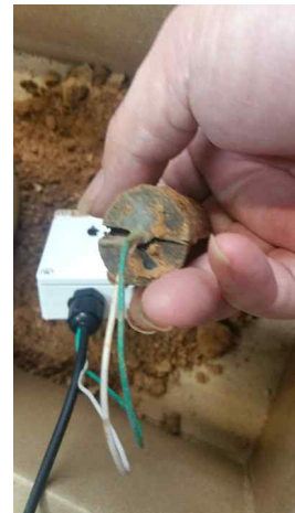
<그림12. 상기그림7 및 그림8의 시험에 사용한 센서모듈1의 상하 접합부와 후면의 형태 >
