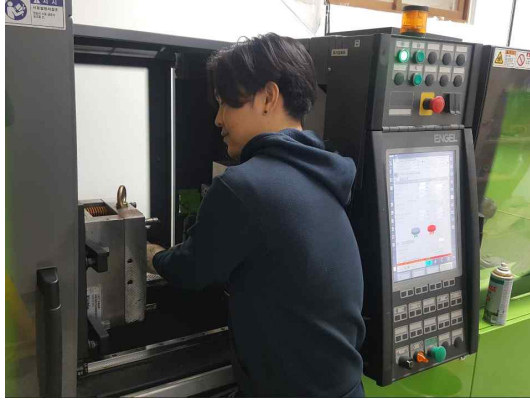
[그림 35] 플라스틱 소성가공기법을 이용한 문양틀 제작
