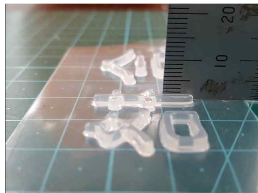
[그림 36] 플라스틱 소성가공기법을 통해 제작한 ‘합격’ 문양(좌), 문양 깊이 측정 사진(우)
