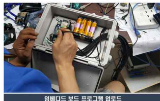
[그림 16] 임베디드 시스템 어셈블리, 임베디드 시스템 전원 공급 및 시스템 프로그램 업로드
