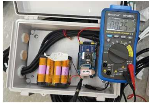
배터리팩 전원 측정
