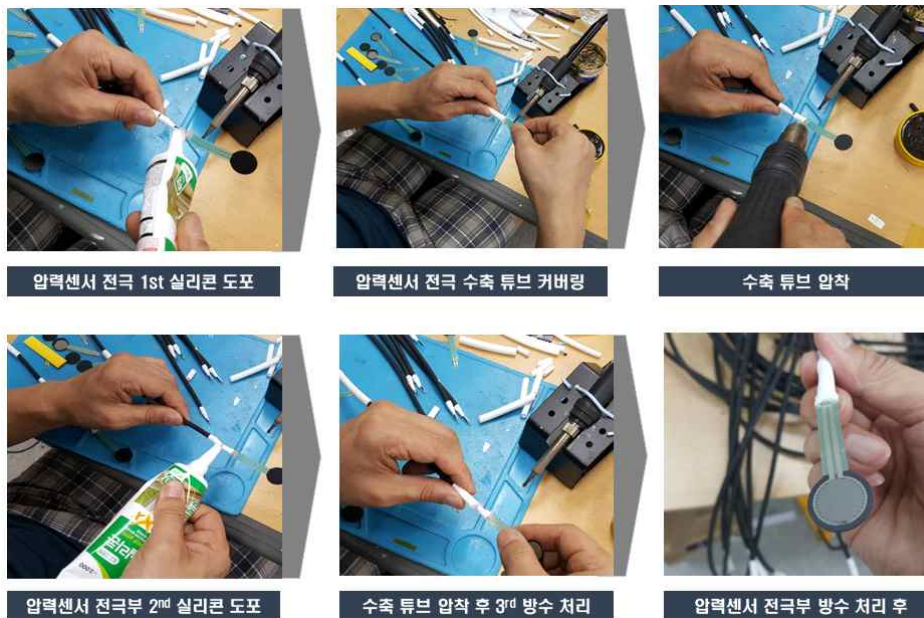
[그림 14] 실리콘 도포, 수축튜브 커버를 사용하여 압력센서와 실드선 연결부 방수처리 작업. 3회 처리
