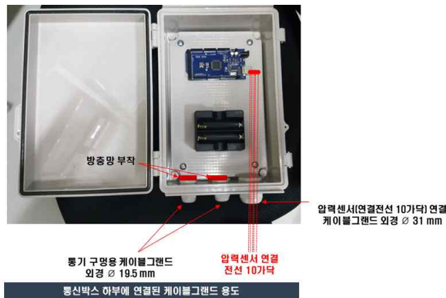
[그림 11] 외곽케이스 하부에 설치된 케이블그랜드와 케이블그랜드의 목적
