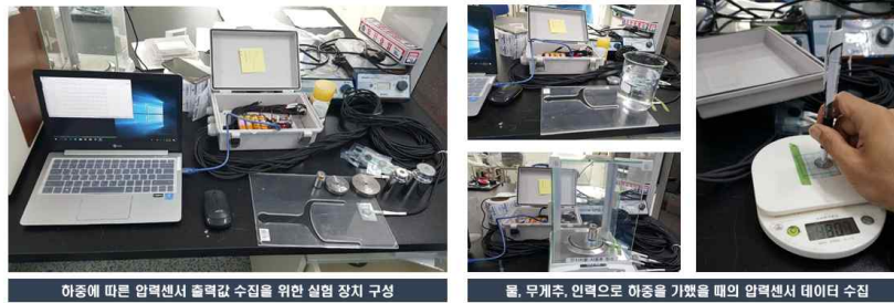
[그림 18] 하중에 따른 압력센서 출력 데이터 수집
