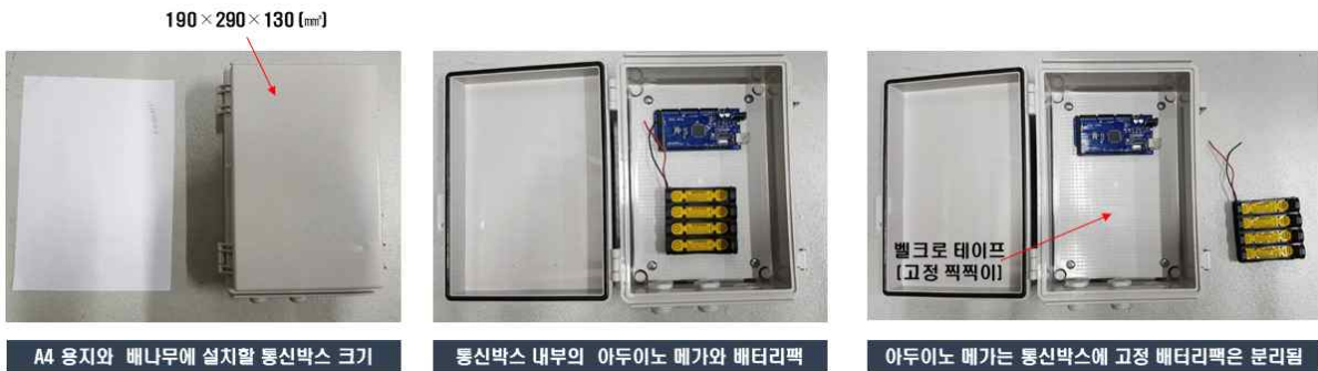
[그림 10] 외곽케이스 크기와 외곽케이스 내부에 설치된 임베디드 시스템, 배터리팩
