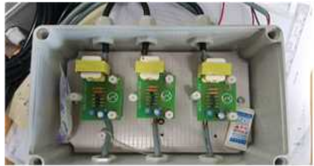
<그림 15> 컨버터를 이용한 환기량 측정 장치
