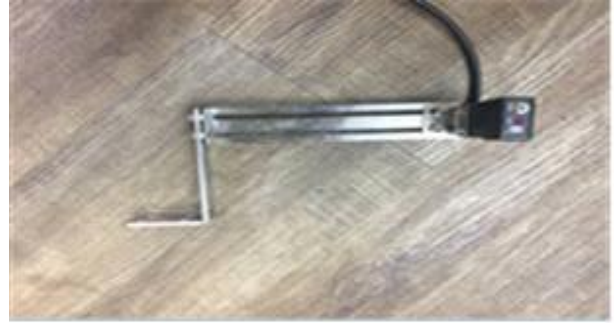
<그림 14> 포토센서를 이용한 환기량 측정 장치
