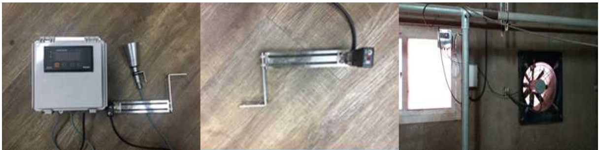
<그림 100> 포토센서를 이용한 환기량 측정 장치
