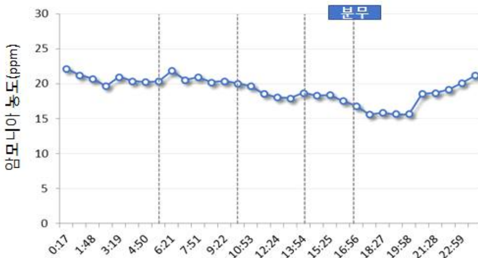
<그림 137> 안개분무시 암모니아 실시간 측정 결과(목초액)
