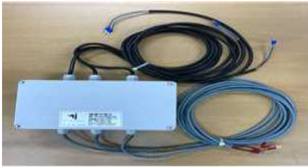
<그림 15> 컨버터를 이용한 환기량 측정 장치
