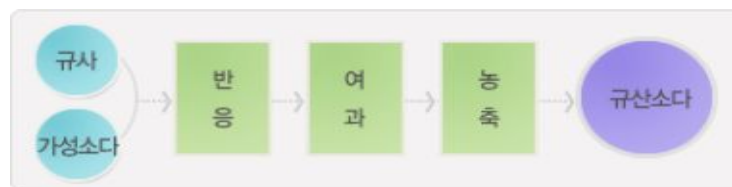
Fig. 5-23. 실리카를 가성소다(NaOH)에 용해하는 방법
