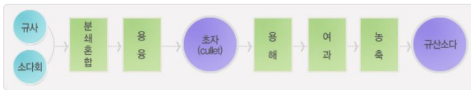
Fig. 5-22. 실리카를 소다회(Na 2 CO 3 )에 용해하는 방법
