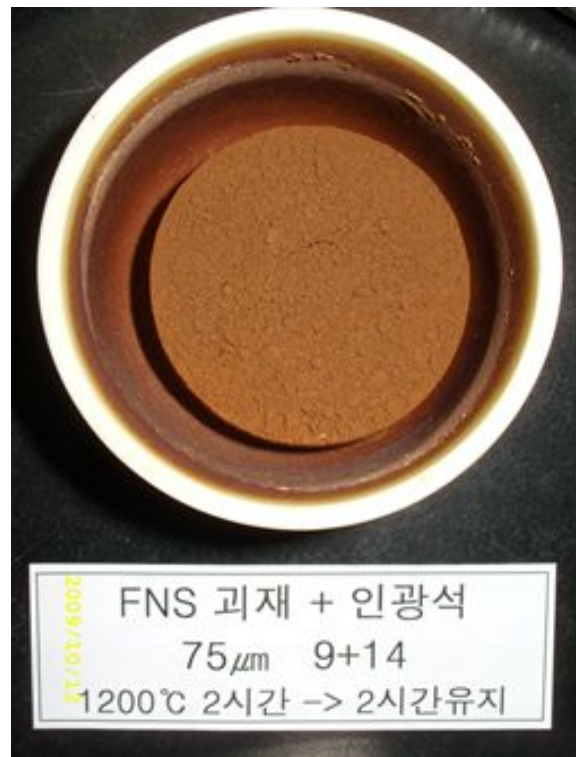
Fig. 3-15. 고온전기로에 반응 후 냉각된 모습
