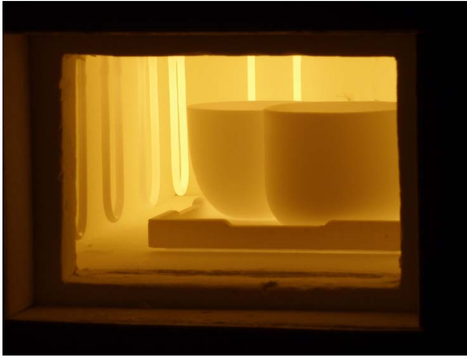
Fig. 3-17. 페로니켈슬래그 규인비료 제조에 사용된 고온 전기로
