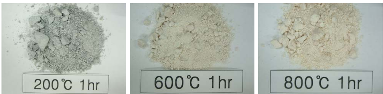
Fig. 5-17. 분리된 SiO 2 하소온도에 따른 변화
