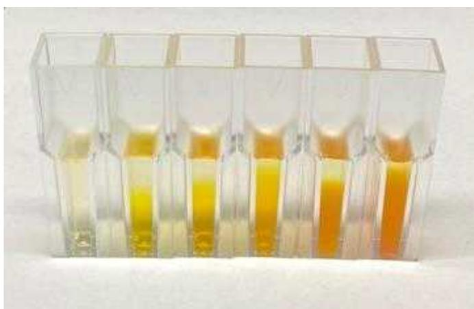
그림 2-8. Nessler's reagent를 이용한 암모니아 생산능력 검정
