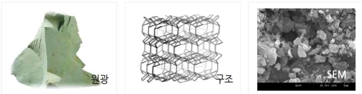
그림 2-25. 제올라이트의 구조 및 형상
