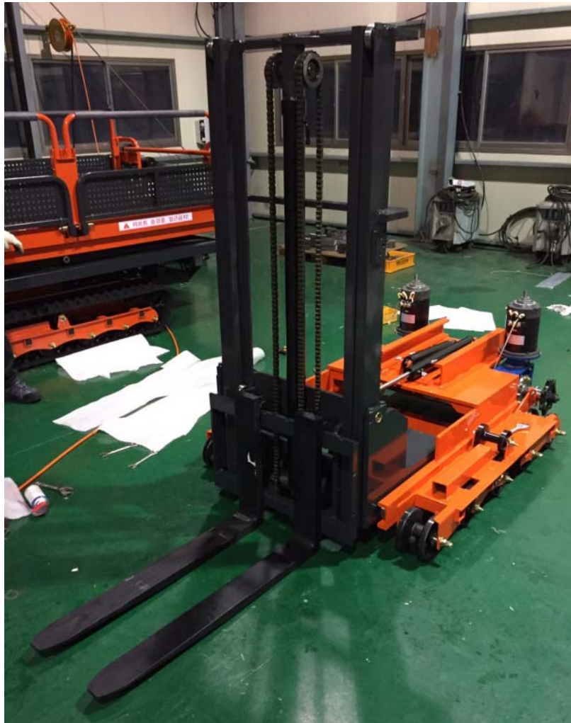
그림 38 포크 및 마스터 레일부 제작
