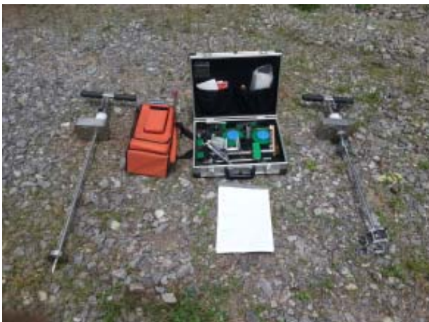
그림 20 토양물리성 측정장치 (SR-2 type)
