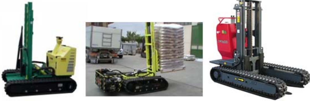
그림 13 해외 엔진 무한궤도형 포크리프트 (좌로부터 MDB, Hinowa사 제품)
