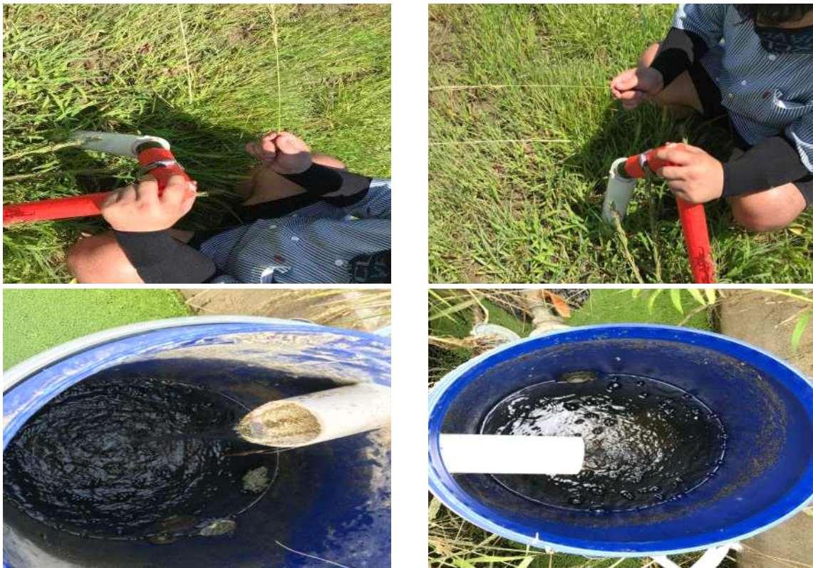
<그림 2-190> 간척지 시험포 무굴착 암거 내부 검토
