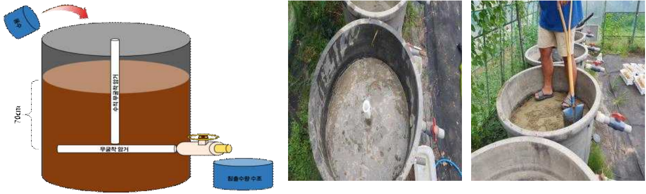
<그림 2-192> 수직배수암거 실내모형실험 모식도 및 전경
