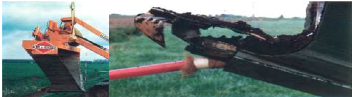
<그림 2-100> V형 쟁기날 방식의 흡수거 매설장치
