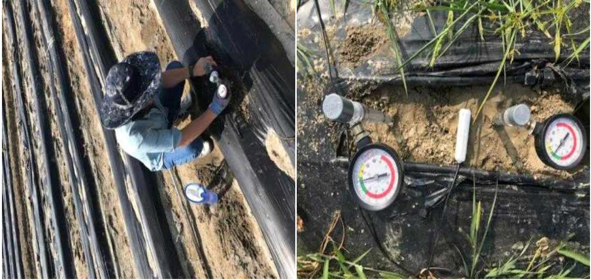
<그림 2-23> 토양수분장력 측정 장치(Tensiometer) 설치 전경
