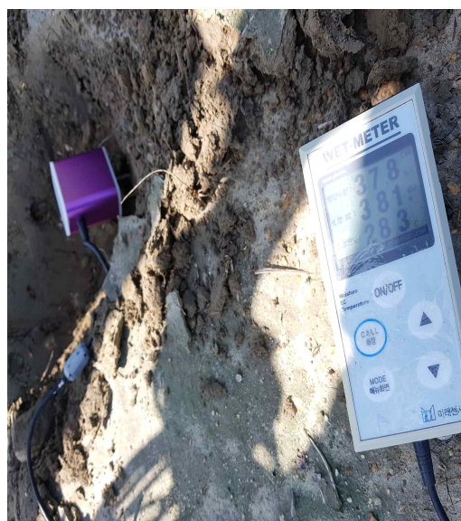
<그림 2-249> 토양 EC와 pH의 현장 측정
