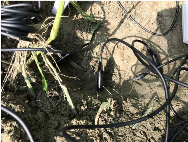
(MPS-6 센서 설치)
