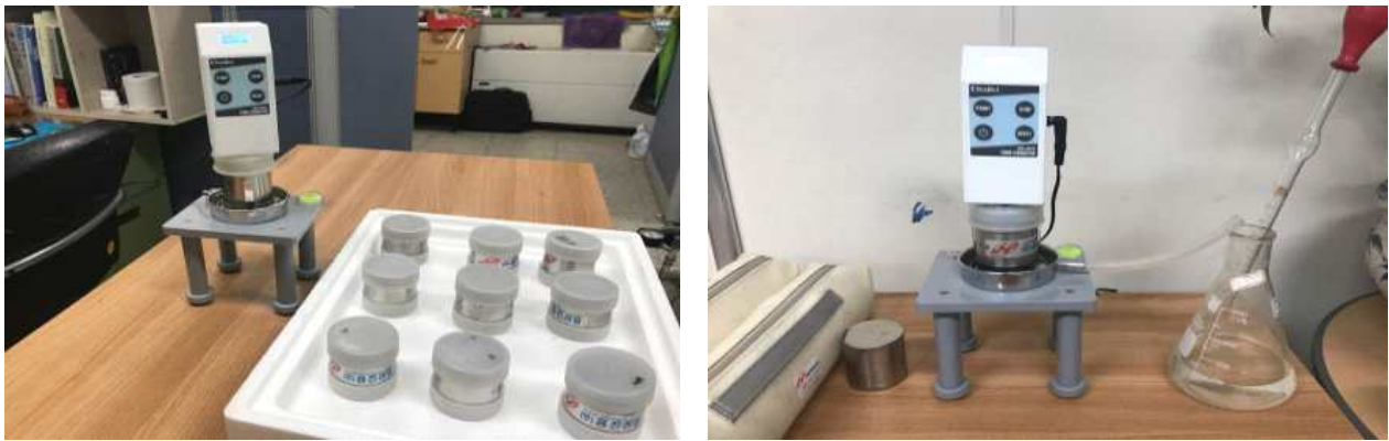
<그림 2-194> 간척지 토양 투수계수 분석 장치 및 측정 전경
