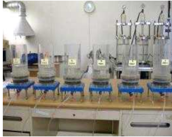
<그림 2-22> 간척지 토양조사를 위한 시료채취 및 침출조사
