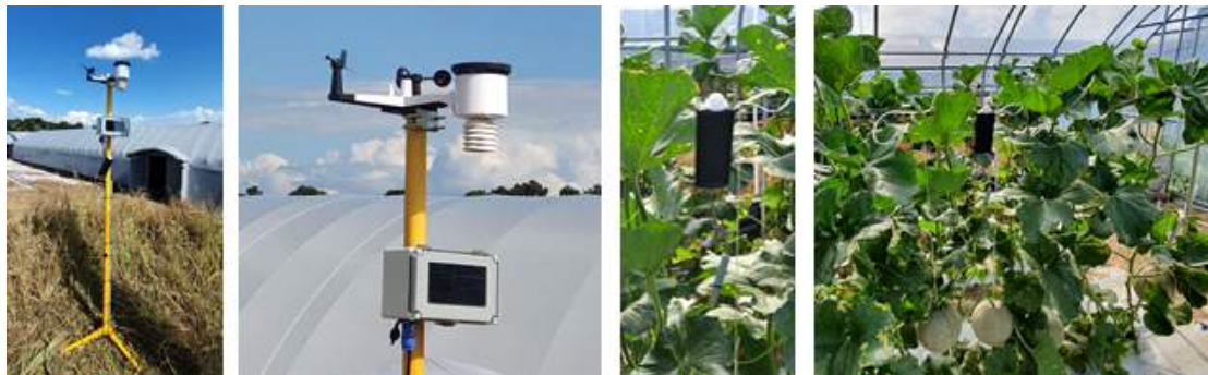
<그림 2-61> 미시기상대 및 소형 환경센서의 활용
