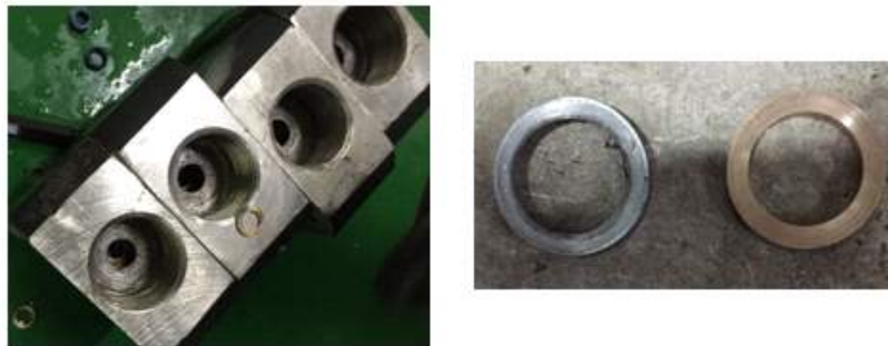
그림 3-13 고압밸브 하부 Sealing 제질 교환
