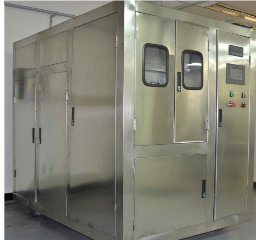
<연세대가 보유하고 있는 초고압 장치(HHP 600 MPa/5 L, BaoTou Kefa, China)의 모식도와 사진>
