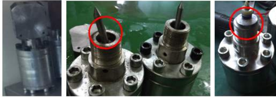
그림 3-12. 고압밸브 상부 Needle 교환 및 고정기 장착
