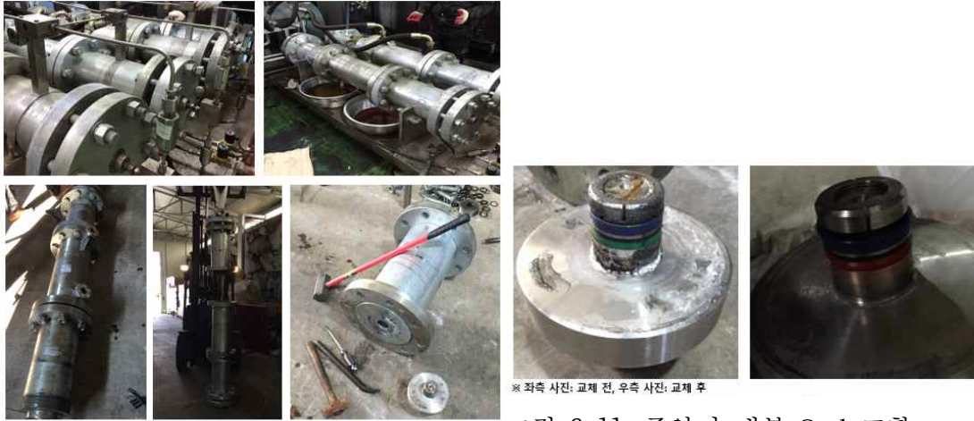
그림 3-11. 증압기 내부 Seal 교환
