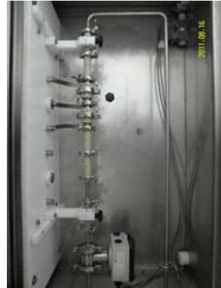
<연구과제에 사용될 펄스 공급장치(좌); 액상 시료의 연속처리를 위한 연속형 펄스처리조 (우)>
